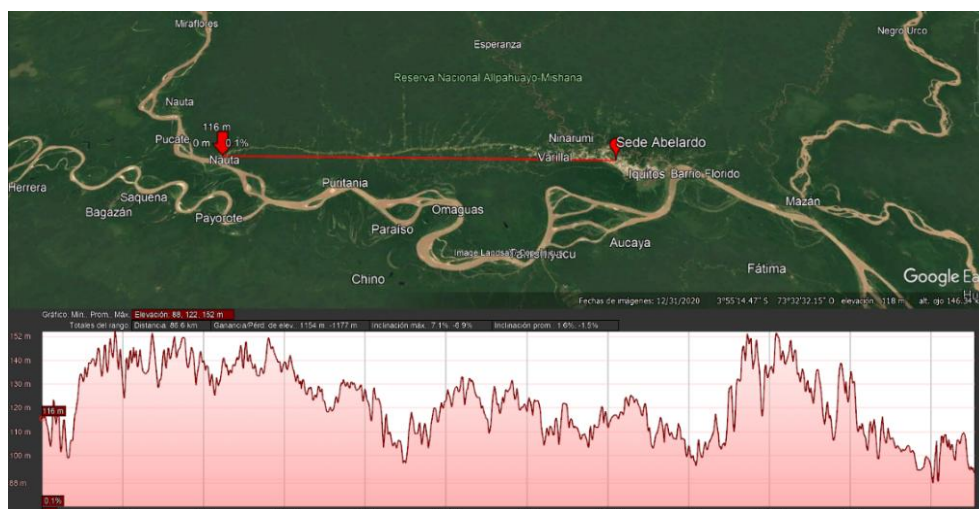
Figura 6 Recorrido del radioenlace para la sede Abelardo. Fuente: Elaboración propia a partir de los datos proporcionados por Ingeniería Técnica y el cliente.
