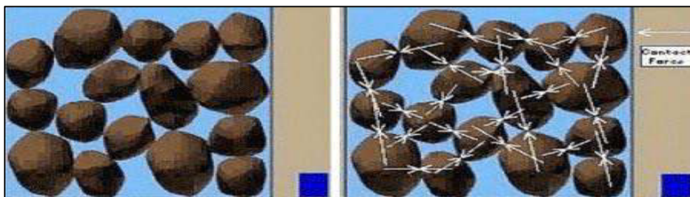
Figura 22. Suelo mal graduado y Proceso de licuación por sismos
