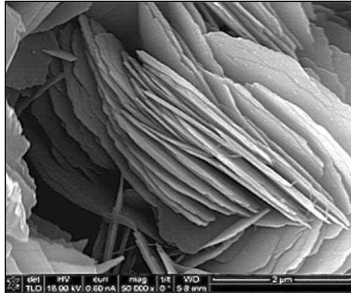
Figura 25. Vista microscópica de una partícula de arcilla
