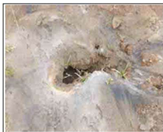
F-4.13.6 "Volcán de arena" producto de licuación masiva de la arena saturada de agua.
