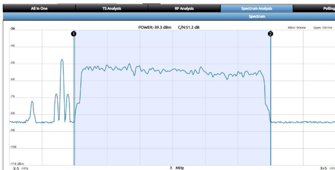
Figura 30: Interfaz del analizador Gsertel: Espectro de la señal recepcionada con marcas en los extremos del canal de 6 MHz. Fuente: Recuperado de la interfaz gráfica del analizador Gsertel.
