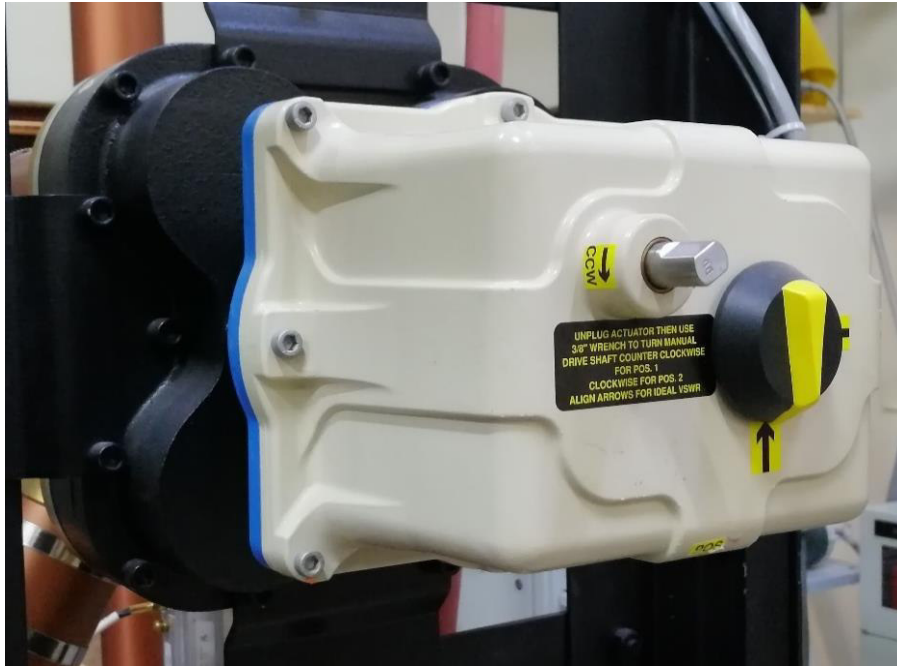
Figura 6: Conmutador coaxial motorizado de 4 vías. Fuente: Elaboración propia.
