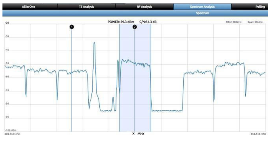
Figura 29: Interfaz del analizador Gsertel: Espectro de la señal receptionada. Fuente: Recuperado de la interfaz gráfica del analizador Gsertel.
