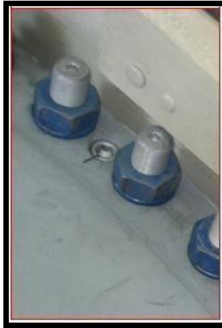
Figura 30: Tuercas Y Arandelas Que Unen La Pala Con El Buje. Fuente: Tomado por la página web Acciona Wind Power – descripción del aerogenerador acciona
