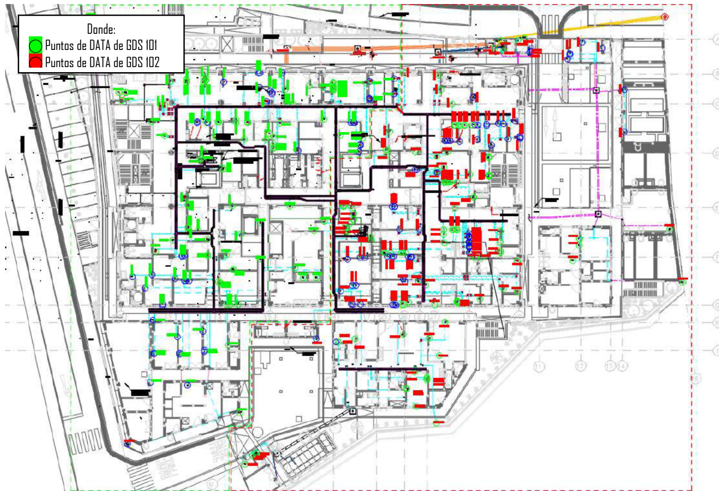
Figura 103. Sistema de Cableado estructurado Primer Nivel. Fuente: Propia
