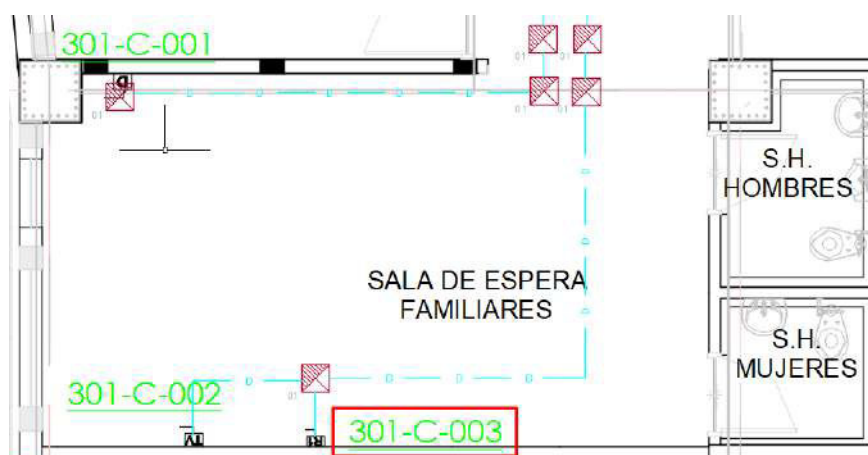
Figura 18. Reloj esfera, será conectado al puerto número 3 del patch panel C en el gabinete número 1 del 3er piso. Fuente Propia
