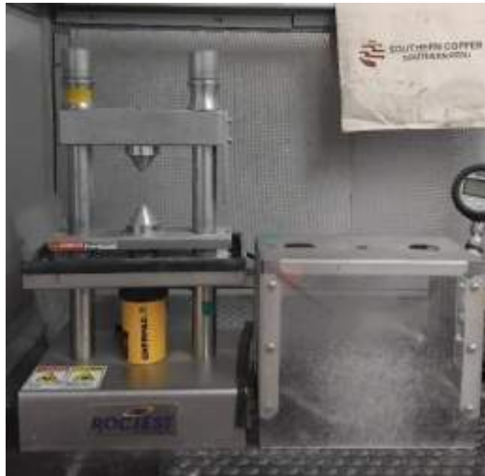
Figura 6. Equipo para ensayos PLT
