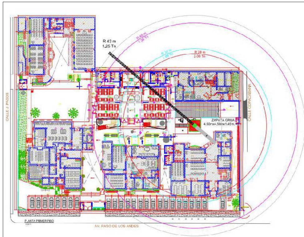
Figura 43. Plano de grúa y los radios máximos del alcance de su pluma Fuente: Planos Asbuilt-Arquitectura-UARM
