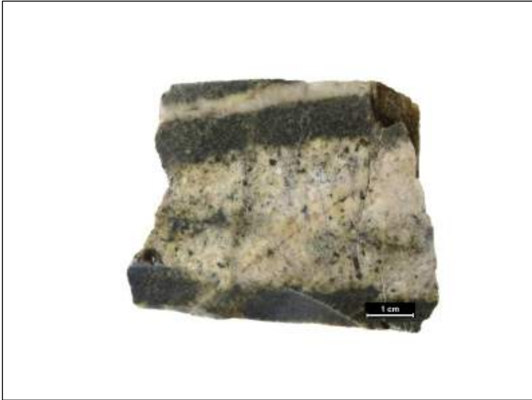
Figura 48. Monzogranito intrusivo con alteración potásica moderada y mineralización de pirita \pm calcopirita (M102-PM)
