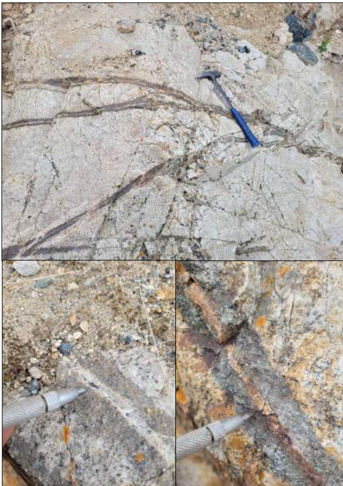
Figura 34. Monzogranito con modera alteración potásica a traslapándose a propilítica profunda con vetillas tempranas de qtz-biotita con halo de clorita siguiendo un control estructural N210. Foto con orientación NW-SE (225457E 8861496N)
