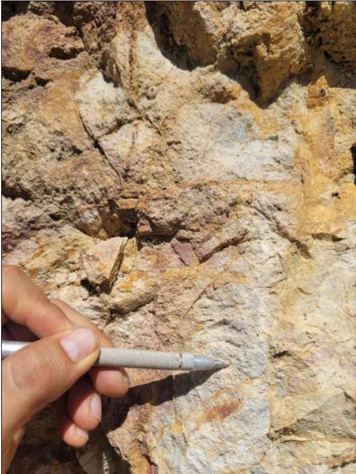
Figura 35. Afloramiento de brechas y venillas hidrotermales con cuarzo y sericita, sulfuro pirita lixiviada a óxidos de hierro
