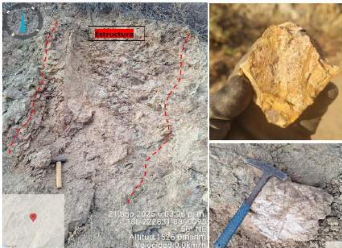
Figura 19. Alteración y mineralización relacionado a estructuras NW-SE
