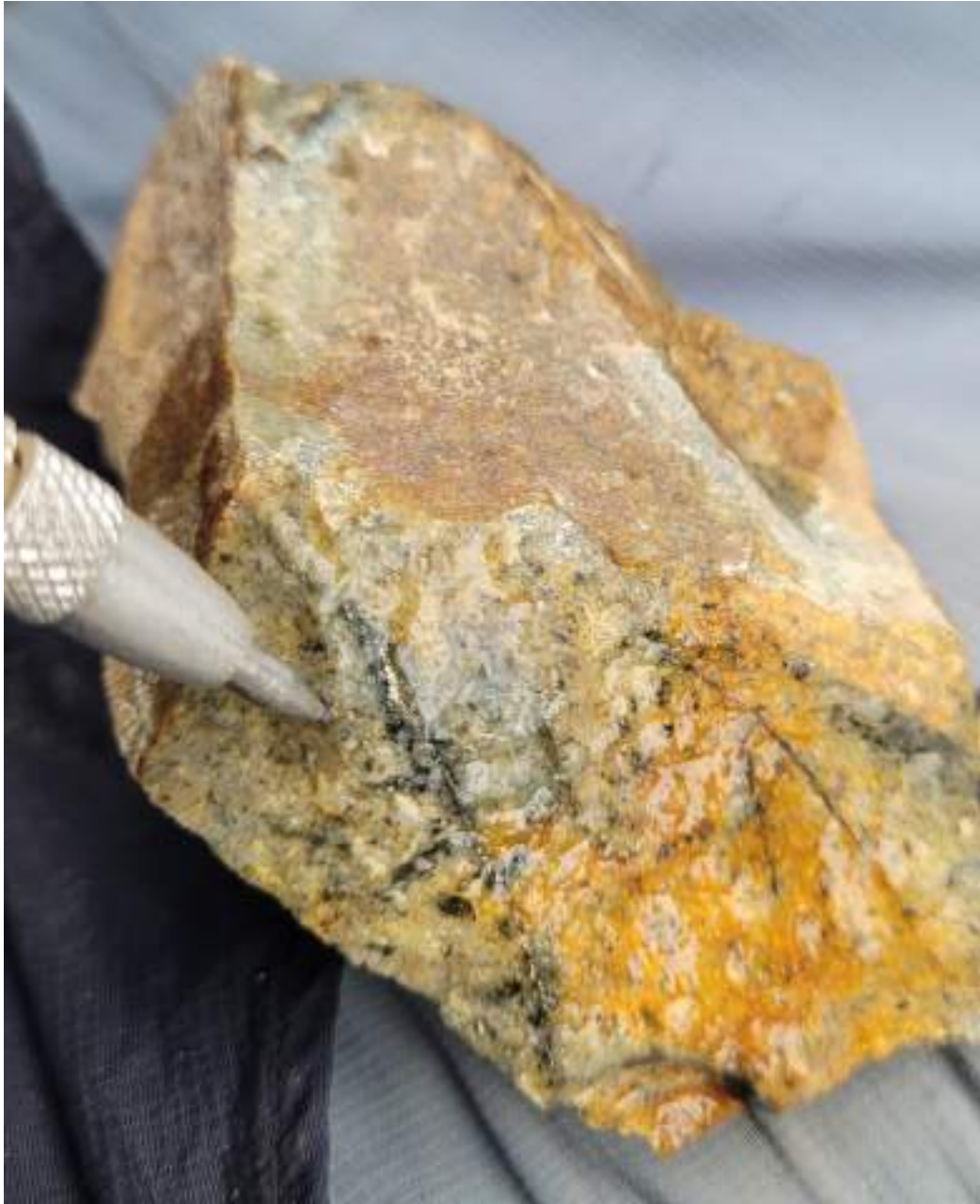
Figura 23. Vetillas de pirita y trazas de calcopirita con halo de clorita
