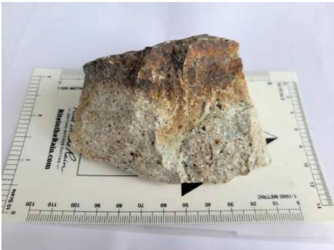
Figura 21. Alteración potásica evidenciado por vetillas de cuarzo con halo de biotita secundaria y clorita
