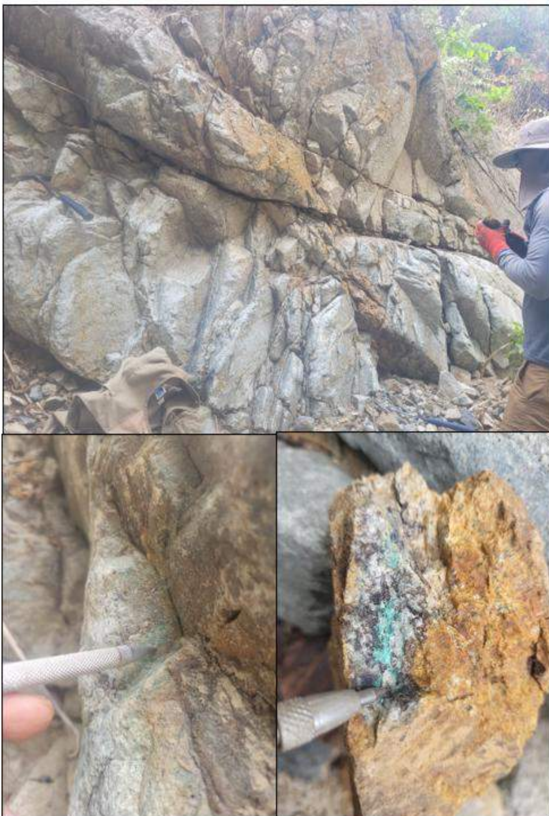
Figura 33. Afloramiento de sienogranito con cobre secundario (malaquita y crisocola) relacionado a estructuras N215. Foto con orientación S-N (225457E 8861496N)
