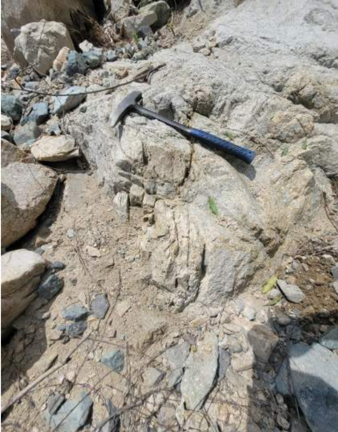
Figura 22. Sienogranito con alteración potásica débil a sub propilítica. Foto con orientación S-N (225457E 8861496N)
