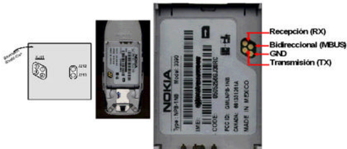
Figura 2.2. Puertos de comunicación del teléfono celular
