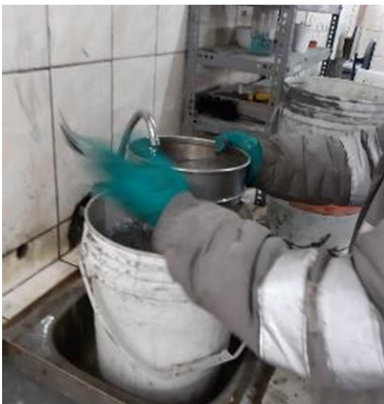
Foto 18. Deslamado de pulpa, sobre la malla número 400 (Tyler).
