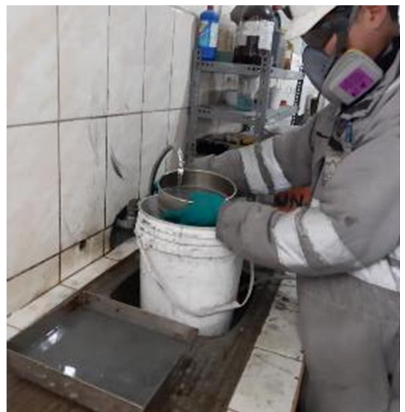
Foto 18. Deslamado de pulpa, sobre la malla número 400 (Tyler).
