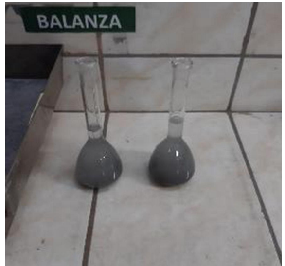
Foto 17. Determinación de Gravedad Específica por el método de la fiola.
