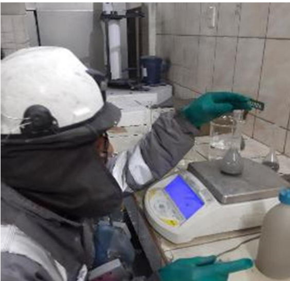
Foto 17. Determinación de Gravedad Específica por el método de la fiola.
