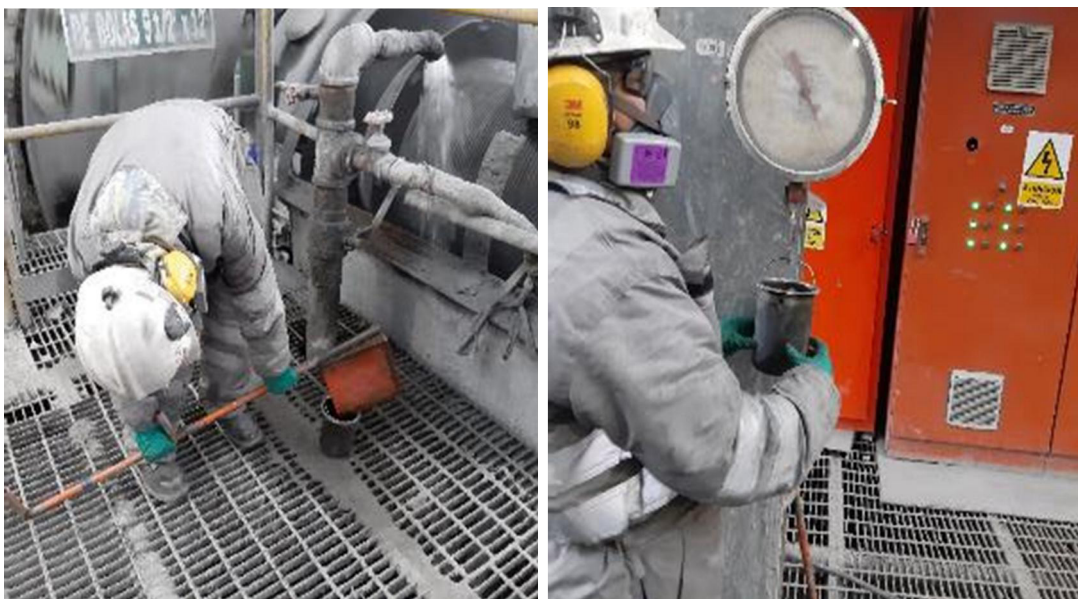
Foto 7. Medición de densidades de Pulpa.
