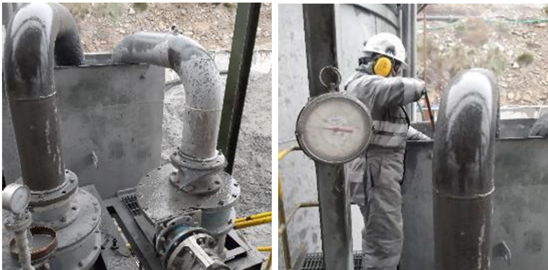
Foto 9. Muestreo en Hidrociclones.
