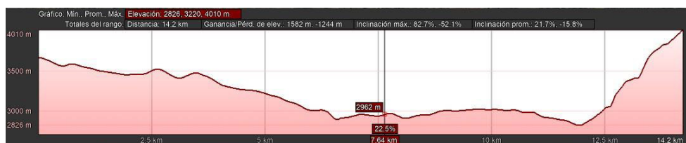
Figura 88. Perfil de elevación del enlace a implementarse. Fuente: Google Earth
