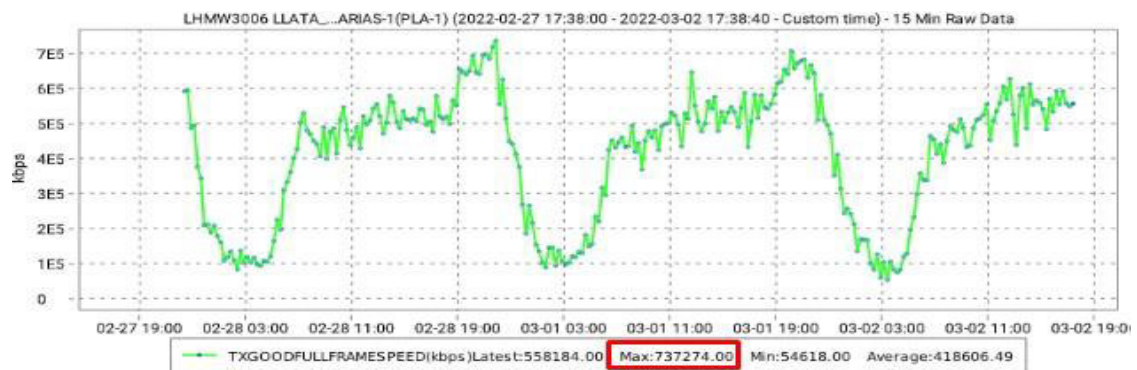
Figura 64. Consumo histórico de tráfico en el sentido Tx del enlace 2+0 XPIC. Fuente: Gestor Web iMaster NCE
