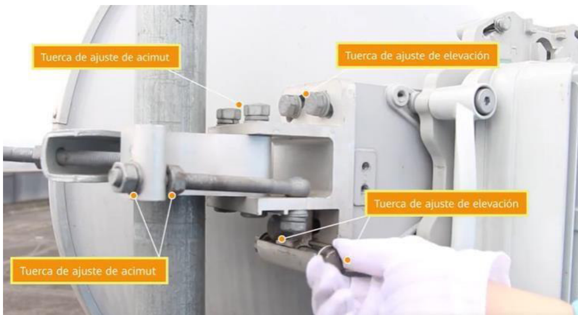
Figura 155. Ajuste de antena de un enlace MIMO 4x4. Fuente: Support Huawei
