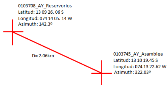
Figura 97. Ejemplificación de Azimuth entre 2 estaciones bases. Fuente: Elaboración Propia
