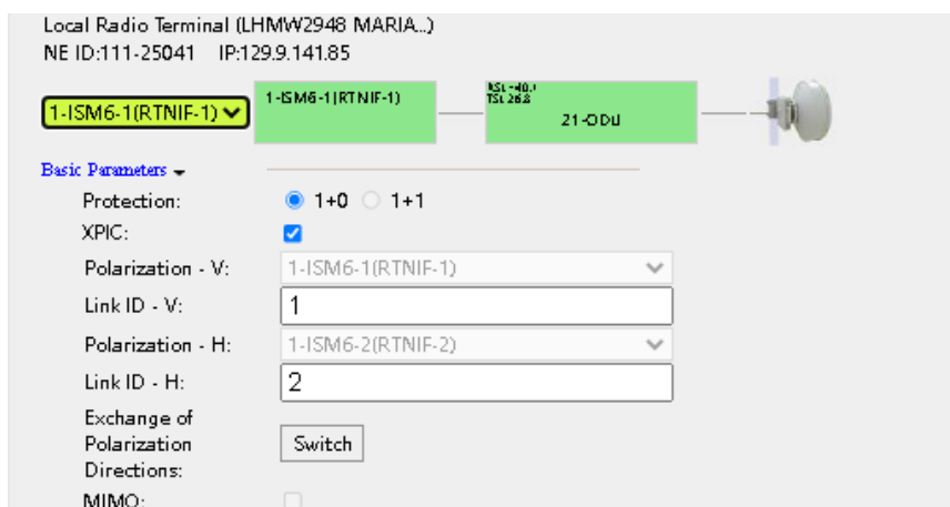
Figura 31. Parámetros básicos de configuración de la 1era portadora usando la polarización Vertical en la estación Marias. Fuente: Gestor Web iMaster NCE
