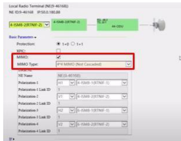
Figura 152. Configuración lógica de un enlace MIMO 4x4. Fuente: Hedex - Huawei Library
