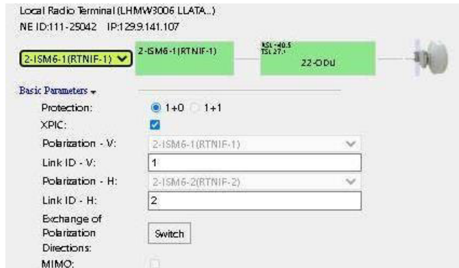
Figura 164. Parámetros básicos de configuración de la 2da portadora usando la polarización Vertical en la estación Llata. Fuente: Gestor Web iMaster NCE
