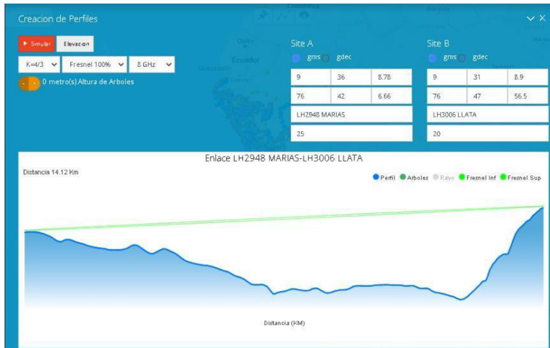
Figura 20. Perfil de un enlace microonda en plataforma GMyD. Fuente: Elaboración Propia
