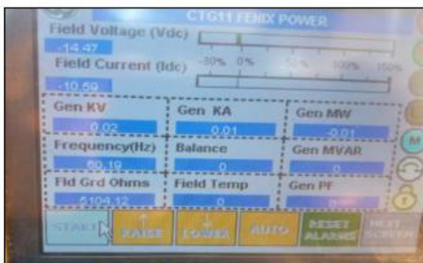
Figura N°7: Valor de resistencia inicial del conjunto de resistencias para la prueba de Alarma del FGD visualizado en el HMI del gabinete
