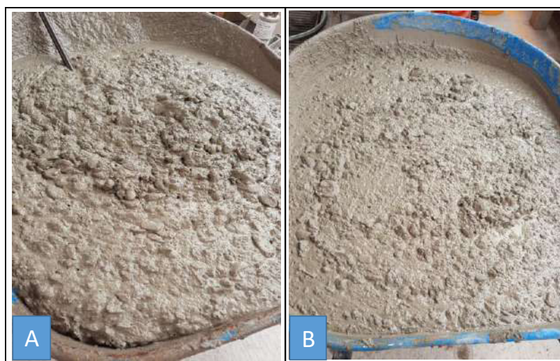
Figura 44. Mezclas de concreto con SCRA y sin SCRA para la observación visual
