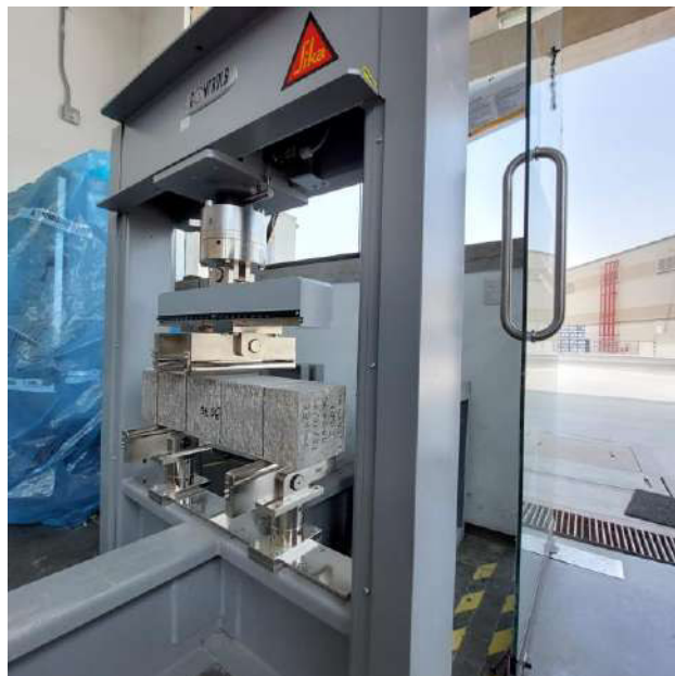
Figura H - 6. Ensayo de vigas de acuerdo a la norma ASTM C78
