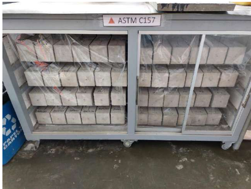
Figura H - 3. Muestras de concreto almacenadas de acuerdo a la norma ASTM C157
