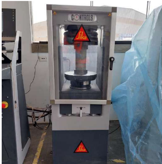
Figura H - 5. Ensayo de Probetas de acuerdo a la norma ASTM C39
