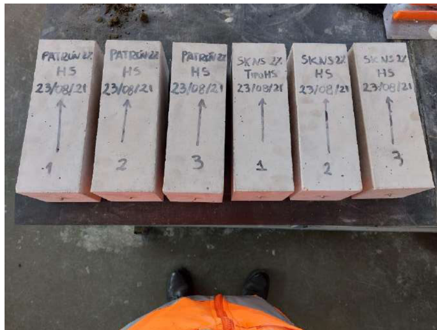
Figura H -2. Identificación de muestras de acuerdo a la norma ASTM C157
