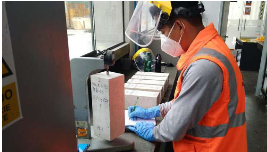
Figura H -1. Medición del cambio de longitud del concreto con Sika control NS
