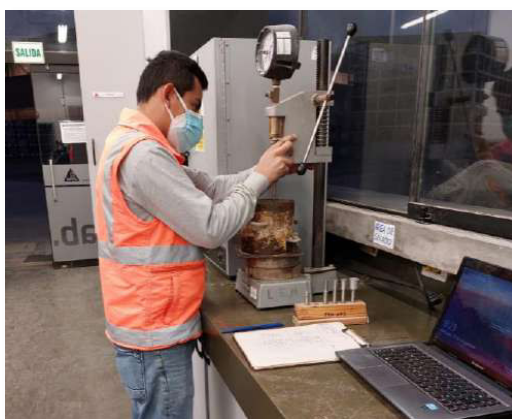
Figura 36. Medición del tiempo de fraguado según la norma ASTM C403
