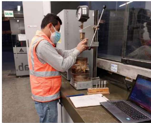
Figura H - 8. Medición del tiempo de fragua de acuerdo a la norma ASTM C403
