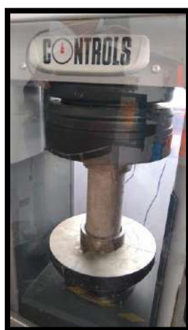
Figura 39. Rotura de probeta en LEM SIKA según la norma ASTM C39
