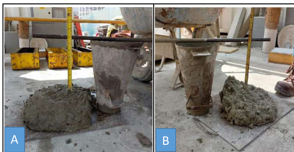
Figura 43. Asentamiento de las mezclas de concreto con SCRA y sin SCRA
