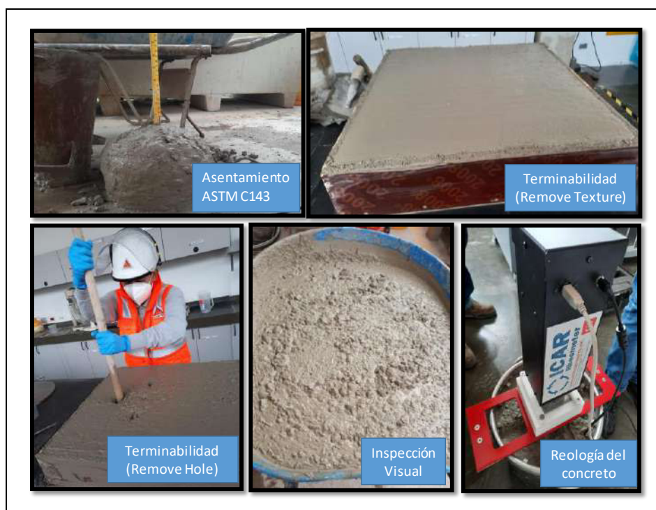
Figura 33. Pruebas realizadas para determinar la trabajabilidad del concreto
