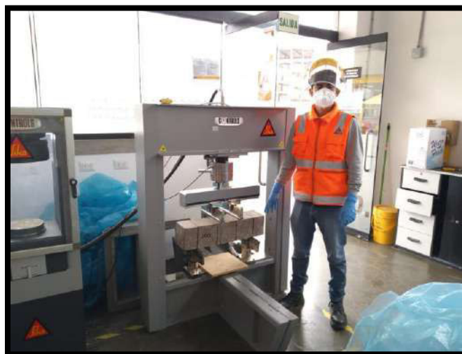
Figura 40. Ensayo de vigas de acuerdo a la norma ASTM C78
