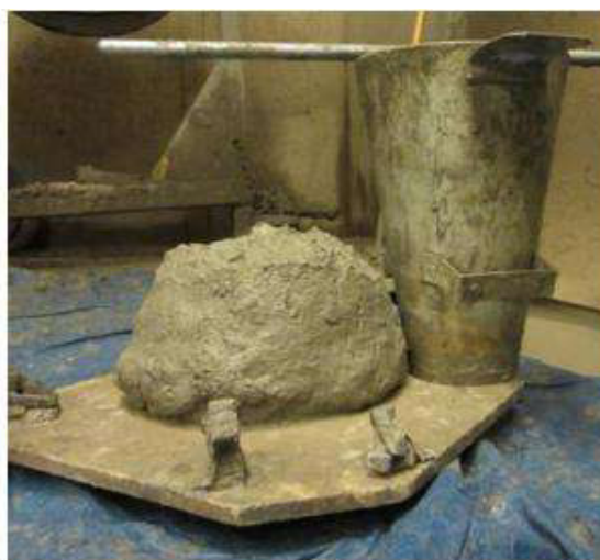
Figura 19. Asentamiento del concreto según la norma ASTM C143
