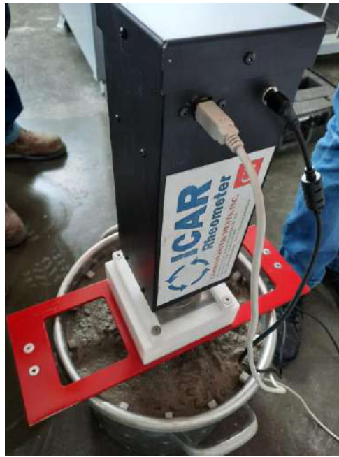
Figura H - 7. Medición de los parámetros reológicos del concreto con Sika control NS
