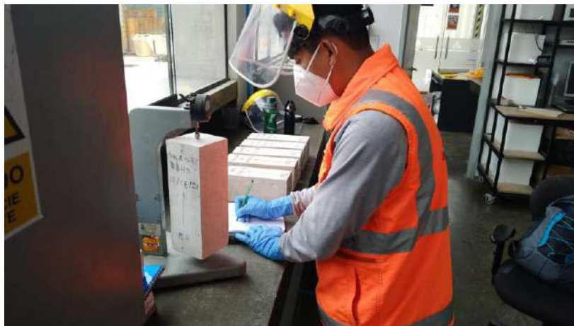
Figura 38. Medición del cambio de longitud según la norma ASTM C157
