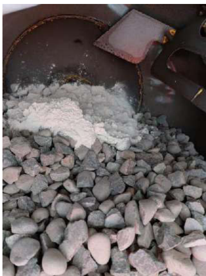
Figura 32. Adición de los agregados y SCRA a la mezcla de concreto
