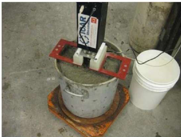
Figura 22. Medición de los parámetros reológicos con el reómetro ICAR
