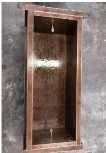
Figura 37. Moldes ASTM C490 con pernos estandarizados
