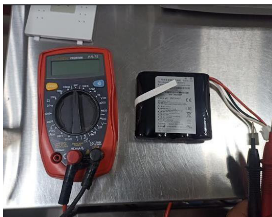
Figura 32. Medición de Voltaje de Batería de Electrocardiógrafo Fuente: Elaboración Propia
