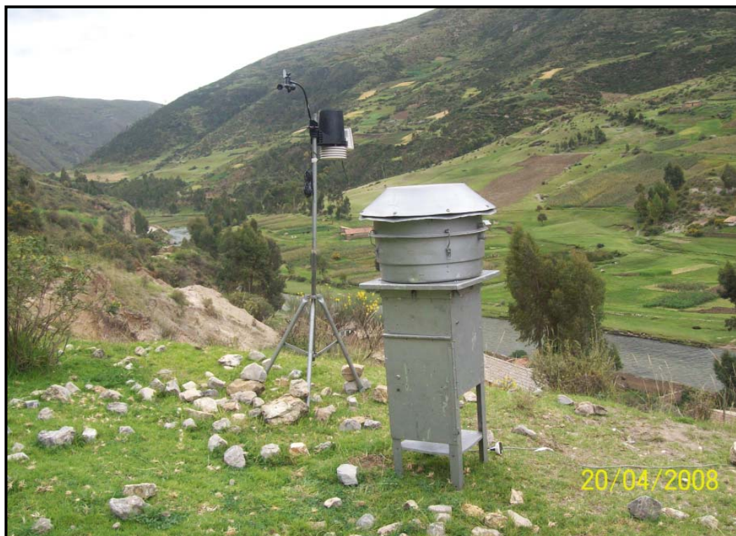
Vista N° 3: Muestreador de alto volumen –HIVOL PM10 marca Graseby Andersen
