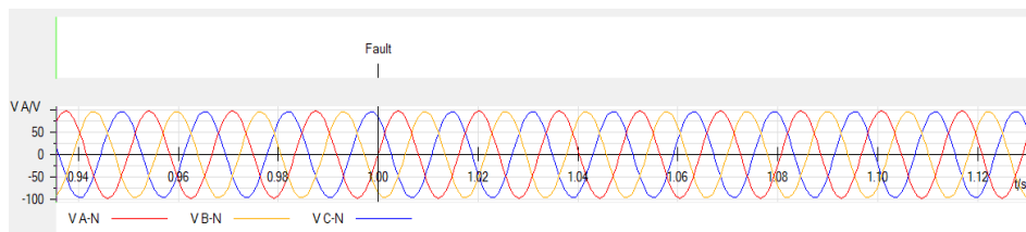
Figura 117 Secuencia de estados función 81O Etapa 1. Fuente. Datos tomados de software Test Universe 4.30 (2021).
