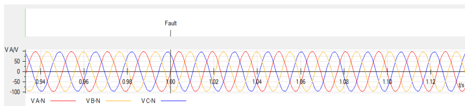
Figura 118 Secuencia de estados función 81O Etapa 2. Fuente. Datos tomados de software Test Universe 4.30 (2021).
