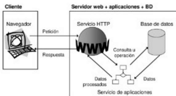
Figura 3. Arquitectura web: Separación servidor de datos (Luján, 2002)
