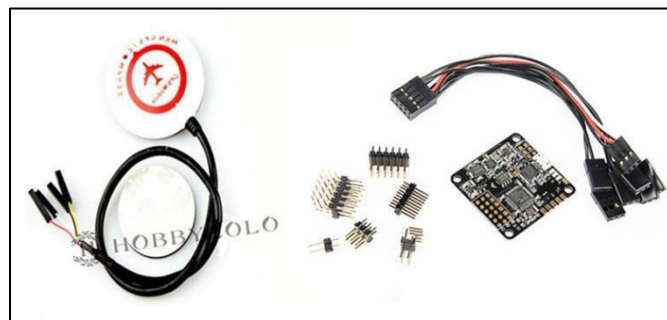
Figura N°3. Ejemplo de un GPS/GNSS para RPA.
