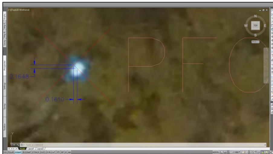
Figura N°36. Desfase planimétrico; ortofoto – punto en Civil 3D.
