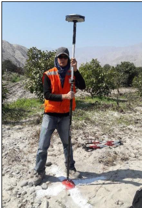
Figura N°33. Toma de medidas de puntos de apoyo fotogramétrico con receptor GNSS.
