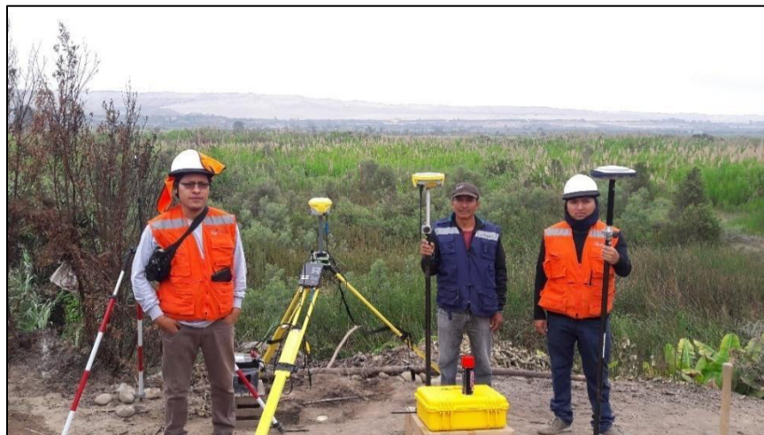
Figura N°24. Trabajos realizados con el método RTK con sistema de radio UHF.
