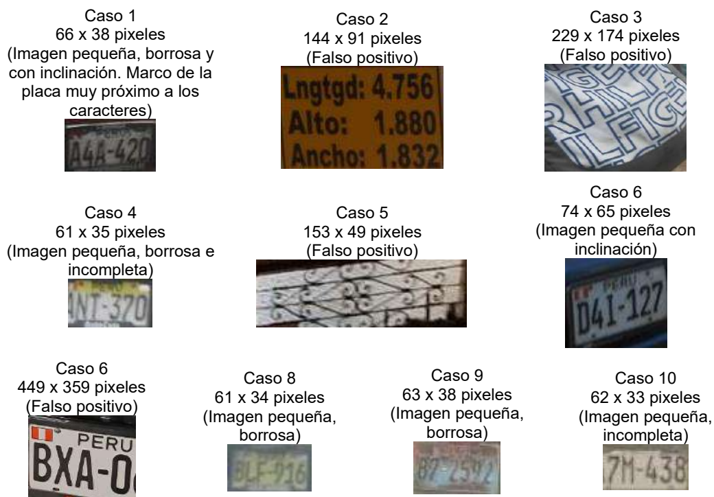
Figura 35. Imágenes generadas por el modelo detector en las que el OCR no pudo reconocer el número de placa.
