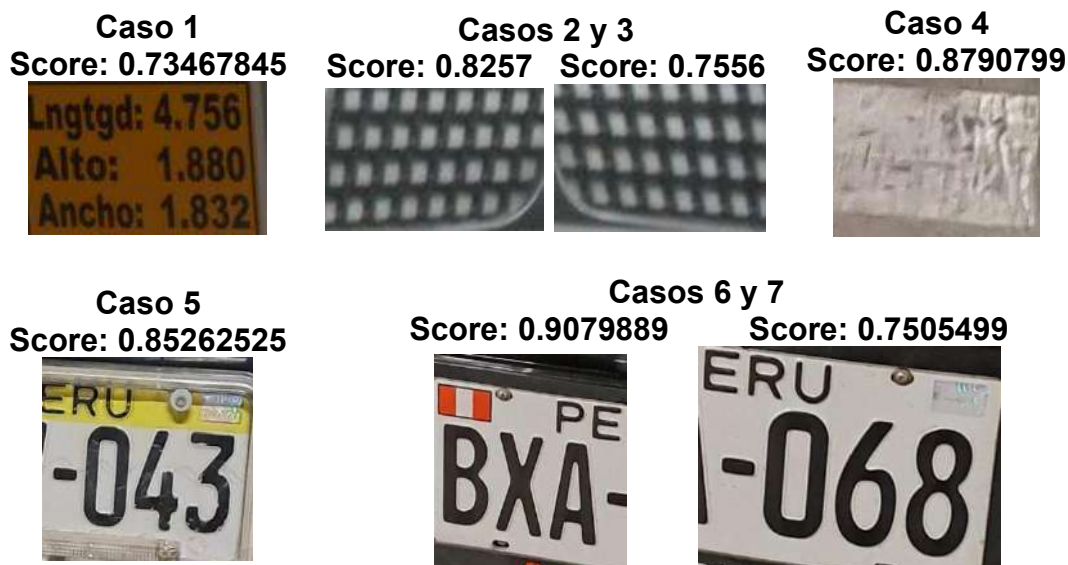
Figura 30. Falsos positivos encontrados durante la evaluación de los tiempos de inferencia del modelo “peruvian_mobilenet_fpnlite_320x320”.
