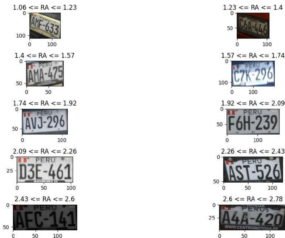
Figura 12. Distribución de la relación de aspecto de las placas de rodaje etiquetadas.
