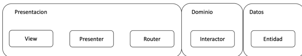
Figura 4: Distribución de los components VIPER mediante el concepto Clean Architecture
