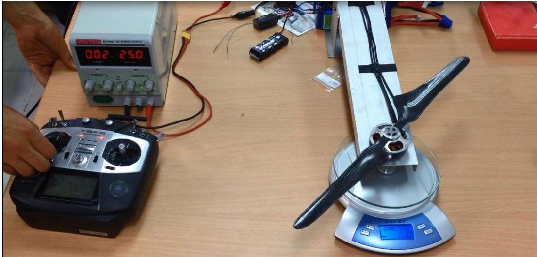
Figura 13 Pruebas de consumo de energía del rotor
