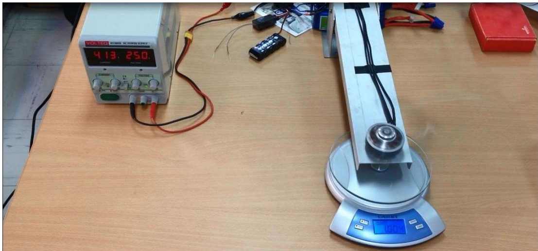
Figura 14 Empuje de rotor a 1kg y consumo de corriente de 4.13 amperios a 25 voltios
