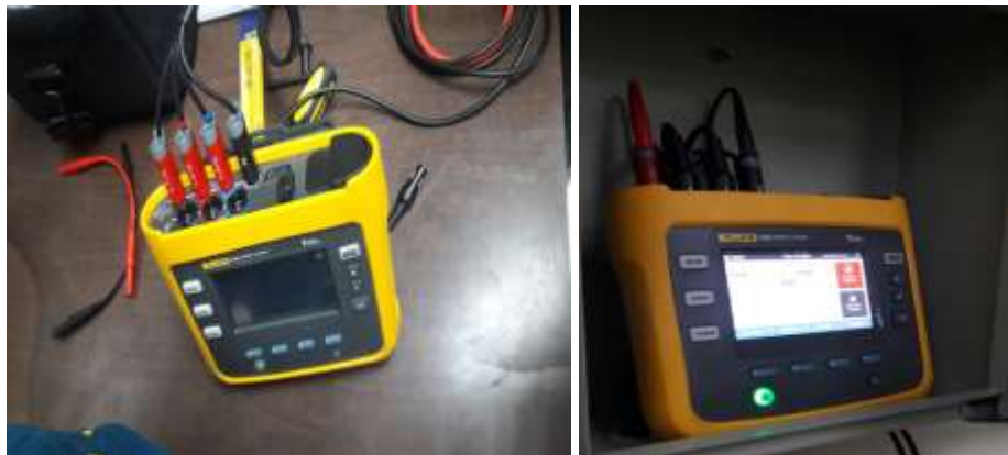
Figura 36. Analizador de carga tipo fluke energy analyze plus 3.3
