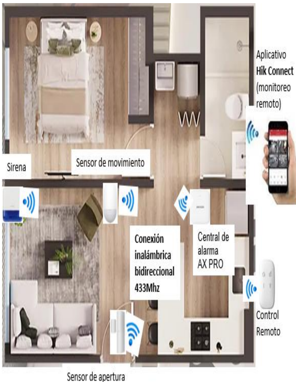
Figura 3 Instalación de sensores de alarma de intrusión. Fuente: Elaboración propia.
