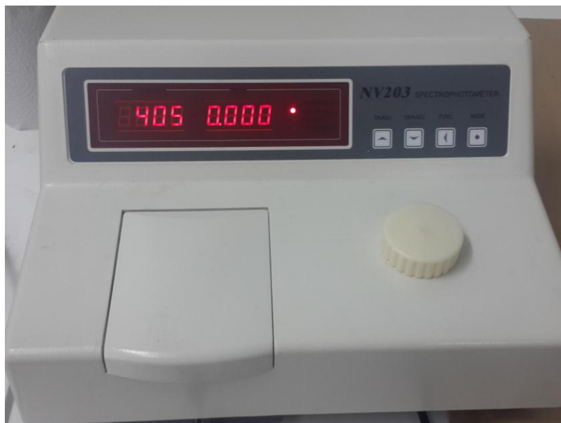
Lectura de absorbancia en espectrofotómetro a 405 nm
