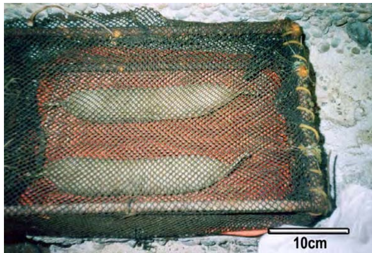
FIGURA 2. Vista superficial de uno de los captadores terminados y listos para ser colocados, en la estación de muestreo biológico, se aprecia en el interior dos madejas colectoras y externamente la malla anchovetera que lo envuelve.
