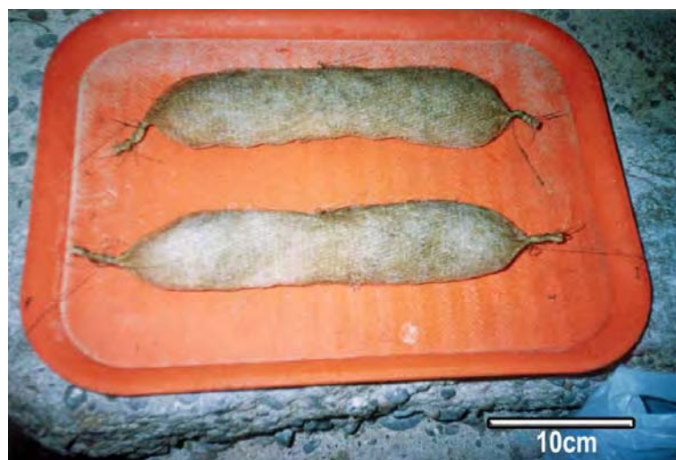
FIGURA 3. Colectores extraídos del captador artificial tras un mes de exposición, a simple vista se aprecia muestra biológica adherida a su superficie.
