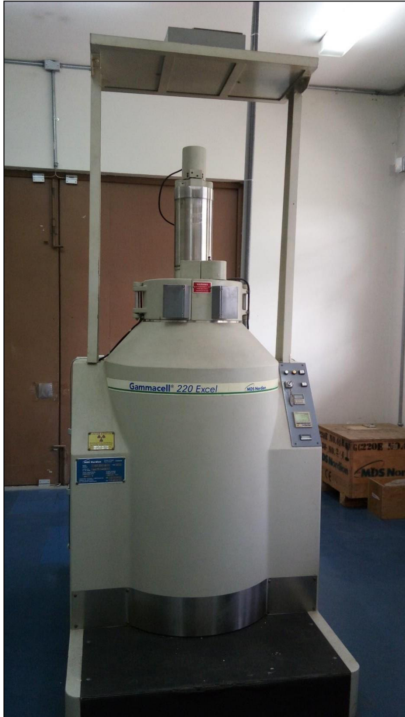
Fig. 52. Equipo de irradiación Gammacell 220 con fuente de Co-60. Aplicación de la radiación gamma a escala laboratorio de investigación
