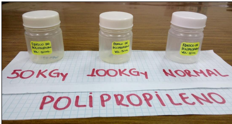
Fig.49. Frascos de polipropileno sometidos a radiación gamma en dosis de 50 KGy y 100 KGy. Pardeamiento
