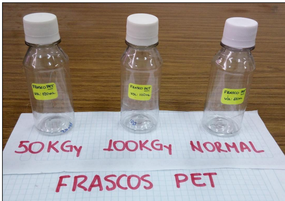
Fig.51. Frascos de polietileno tereftalato transparente sometidos a radiación gamma en dosis de 50 KGy y 100 KGy. Mayor resistencia a la irradiación
