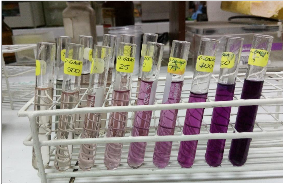
Fig. 61. Curva de calibración para la cuantificación de ácidos urónicos por reacción con carbazol sulfúrico
