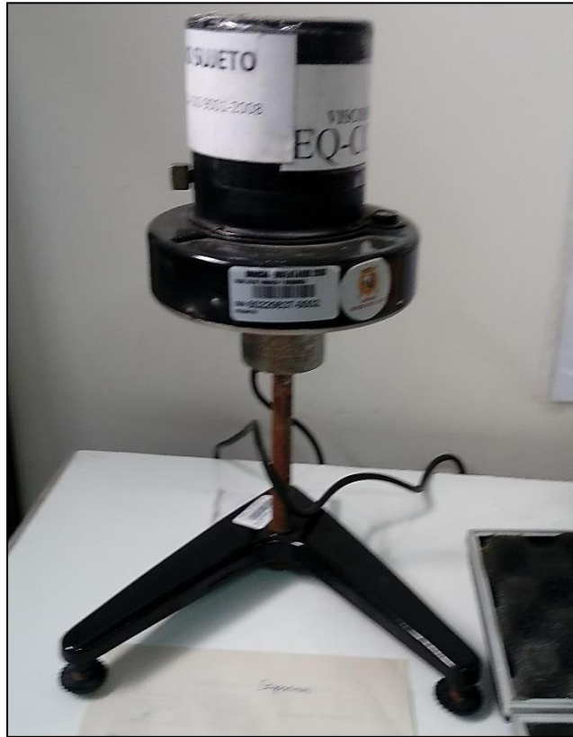
Fig. 67. Viscosímetro de Brockfield utilizado para la determinación de viscosidad de las muestras de fucoidano irradiados
