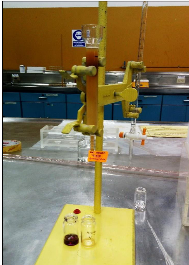
Fig. 56. Cromatografía de exclusión. Corrida en columna cromatográfica cargada con fucoidano
