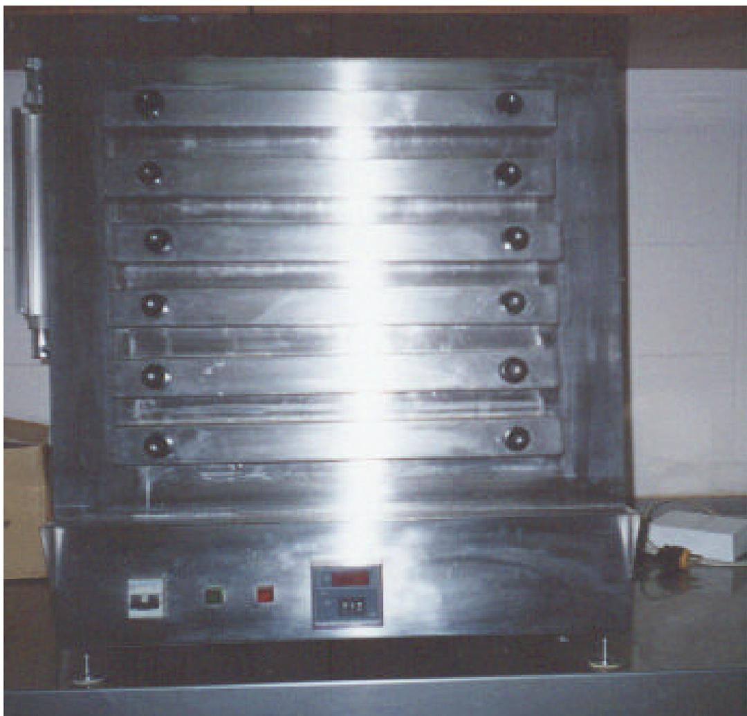
FIGURA 11. Coagulador para los medios de cultivo. Para la preparación de los medios Löwenstein-Jensen, los tubos fueron colocados en plano inclinado a temperatura de 84 °C por 45 minutos.
