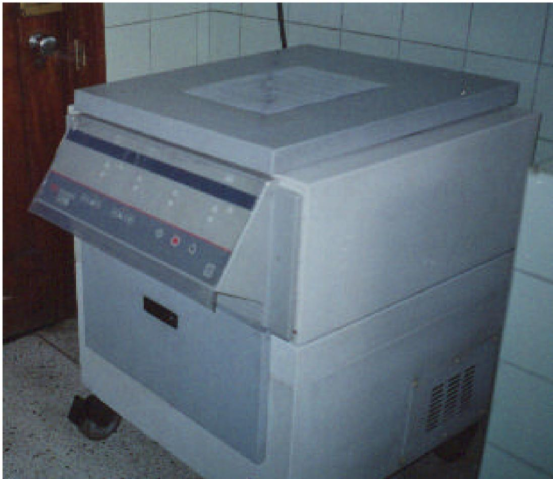
FIGURA 12. Centrífuga a prueba de aerosoles. Donde se concentraban las muestras a 3000 RPM por 15 minutos; antes de ser sembrados en los medios de cultivo Löwenstein-Jensen convencional y modificado.
