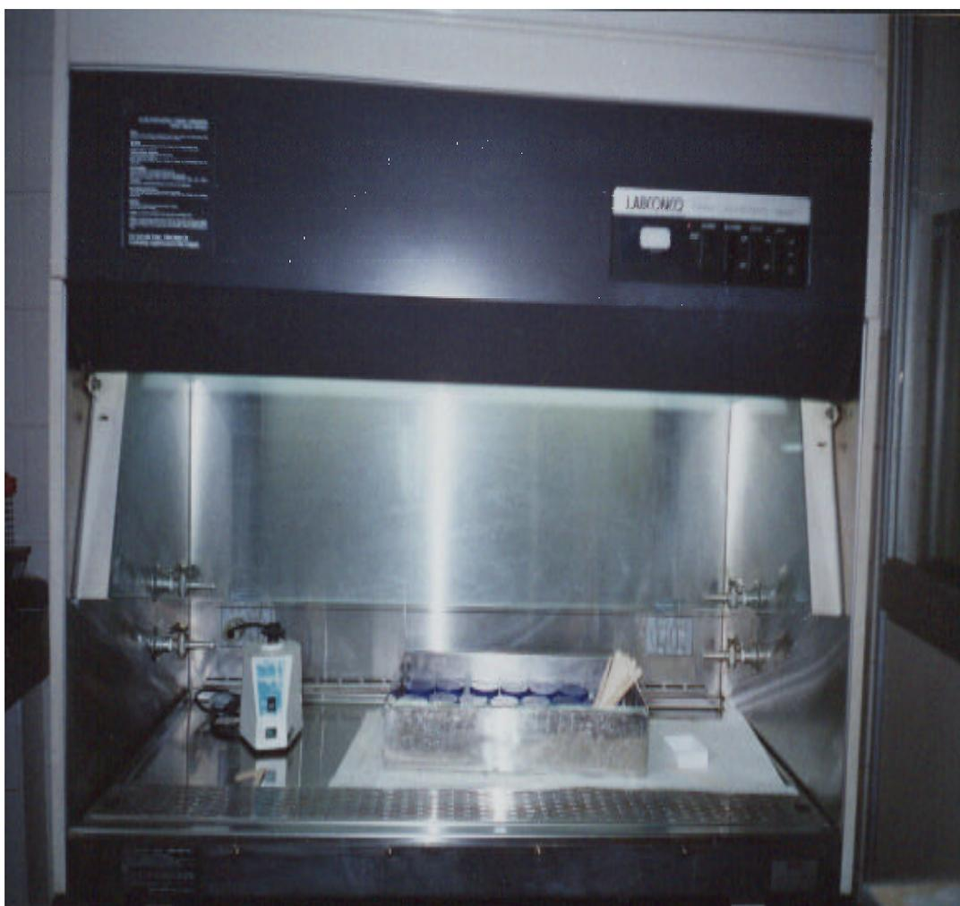
FIGURA 10. Cabina de seguridad de flujo laminar. Para procesamiento de las muestras para diagnóstico de tuberculosis.
