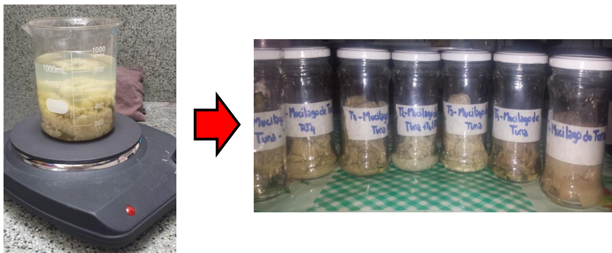
Figura 23 Lavado y filtración, se obtiene el mucilago en base húmeda
