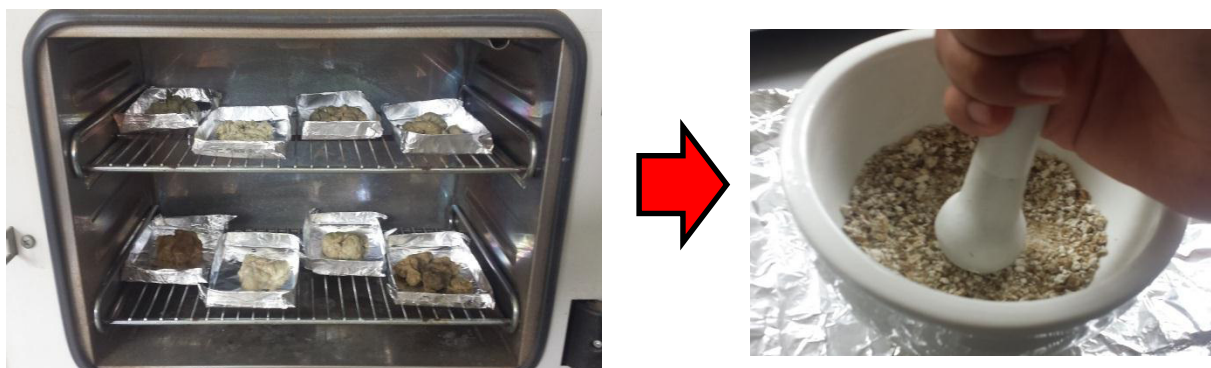
Figura 24 Secado y molienda del mucilago seco.
