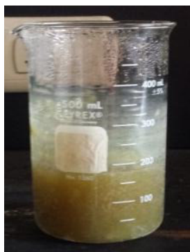
Figura 21 Precipitación con alcohol etílico.
