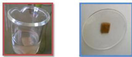
FIGURA N° 15 APÓSITOS CON EXCESO DE \text{NaBH}_4(10^{-2}\text{M})
