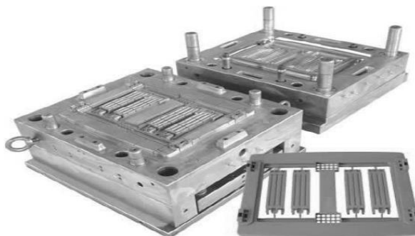
Figura 68. Molde (Superior) - Producto Moldeado (Inferior Derecha). Fuente: Roshanaei, 2012
