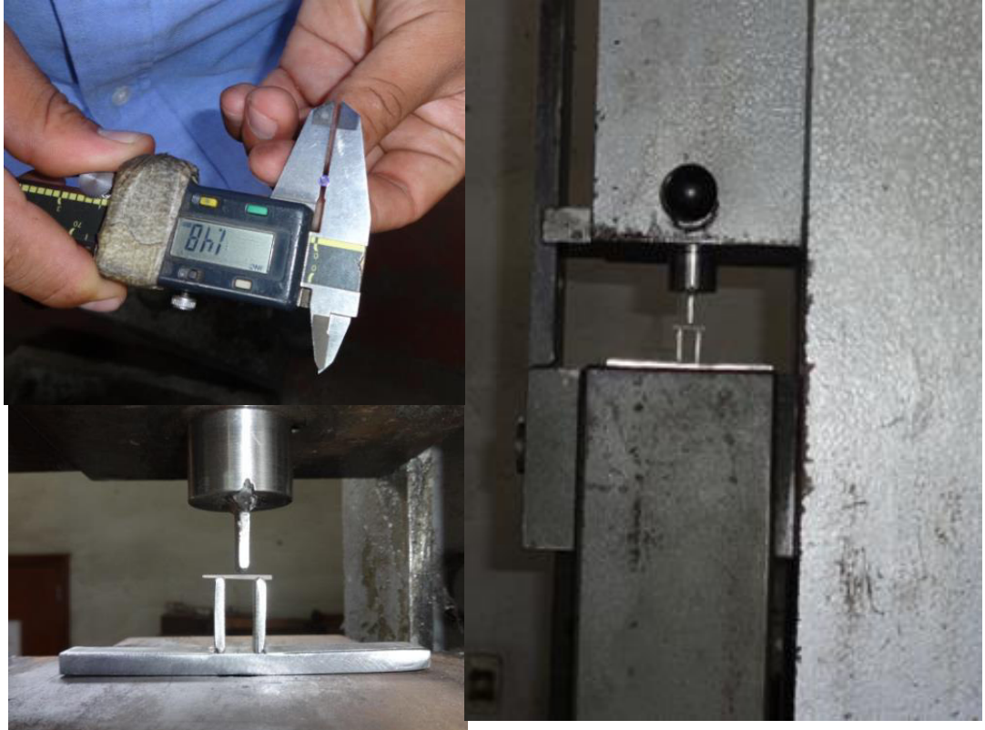
Figura 10. Medición de los espigos y montaje en la máquina de ensayo universal
