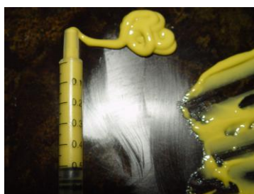
Figura 40. Eliminación de excedentes de la silicona Mezcla Propuesta hasta los 0.5 ml según la especificación n 19 ANSI/ADA
