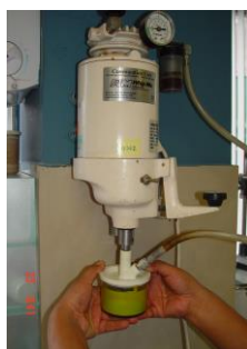
Figura 7. Mezcladora al vacío marca Whip Mix en proceso de mezcla de las proporciones 2:1 de fluida y pesada respectivamente
