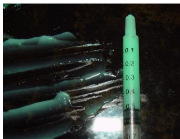
Figura 33. Eliminación de excesos hasta exactamente 0.5 ml como exige la prueba de diámetro de consistencia especificación n ° 19 ANSI/ADA
