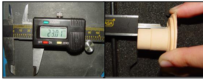
Figura 22. Medición de la altura total= altura 1 + altura 2= 23.01 mm
