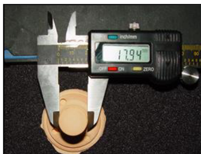
Figura 21. Medición del diámetro 2 del sector 2 con el calibrador electrónico
