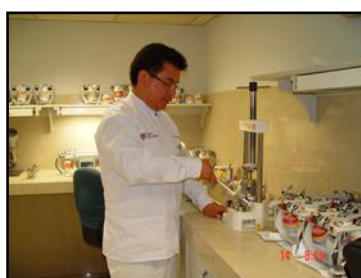
Figura 51. Activando la prensa hidráulica marca Zhermack modelo EMME VI PO3 del laboratorio de Prótesis Dental de la Facultad de Odontología de la USMP
