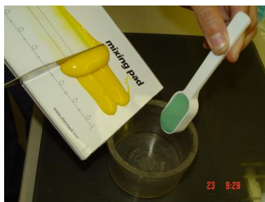
Figura 18. Vertido de los materiales al pote de mezcladora de vacío
