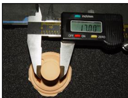
Figura 20. Medición del diámetro menor del sector 1 con el calibrador electrónico
