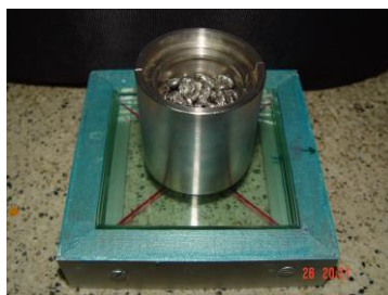
Figura 35. Aplicación de la pesa y platina de vidrio (575 gr durante 12 minutos) sobre la silicona Speedex Medium tipo 2 activada
