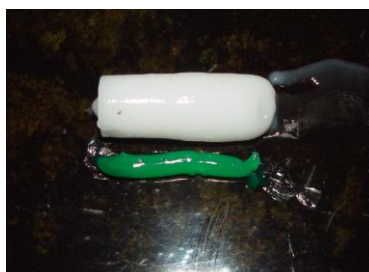
Figura 30. Silicona Speedex Medium tipo 2 Coltene con activador listos para la mezcla y prueba del diámetro de consistencia
