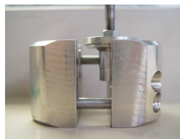
Figura 3: Proceso de acoplamiento del patrón metálico y cubo “cubeta” 1 con los pines centradores
