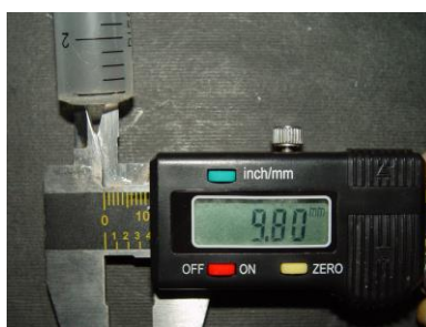
Figura 24. Calibrando el diámetro de la boquilla de la hipodérmica
