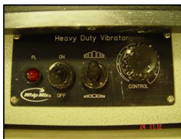
Figura 59. Vibradora de yeso marca Whip Mix modelo Heavy Duty del laboratorio de Prótesis Dental de la Facultad de Odontología de la USMP.
