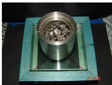
Figura 42. Aplicación de la pesa y platina de vidrio (575 gr durante 12 minutos) sobre la silicona Mezcla Propuesta
