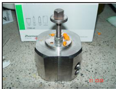
Figura 53. Retiro del dispositivo de la prensa hidráulica, esperando los minutos recomendados por el fabricante para el desmontaje del patrón metálico
