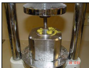
Figura 52. Patrón metálico completamente asentado dentro del cubo metálico que contiene la silicona. Obsérvese la salida del material de impresión por los desfogues del dispositivo para disminuir la presión hidráulica.
