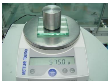
Figura 27. Comprobación del peso para la prueba del diámetro de consistencia especificación n ° 19 ANSI/ADA
