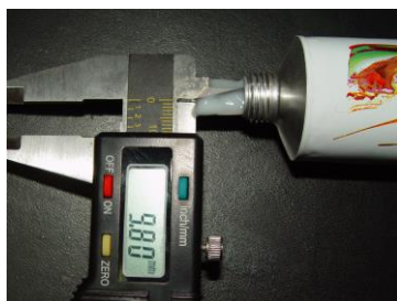
Figura 25. Calibrando el diámetro de la boquilla del tubo de presentación de la Speedex Medium ADA tipo 2 Coltene
