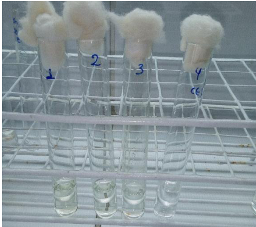
Fig.7.Tubos con soluciones preparadas:1:NaOCl al 5,25%; 2:NaOCl al 2,5%; 3:CaOCl al 2,5%y 4: Agua
