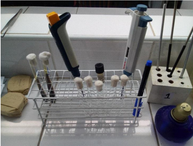
Fig.3.Mesa de Trabajo que contiene: Micropipetas, asas de siembra, mechero, tubos de ensayo y medios de cultivo Bilis Esculina.
