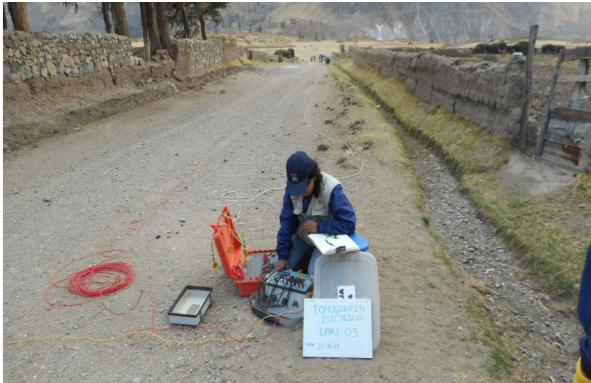
Figura38. Equipo de resistividad eléctrica utilizado en Madrigal
