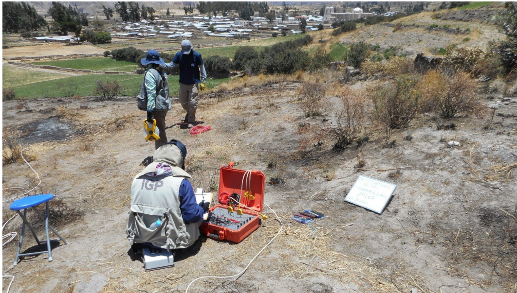
Figura 43. Toma de datos de resistividad eléctrica en campo
