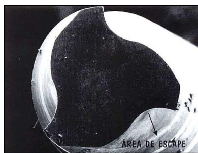
Fig 12B. Área de escape del instrumento K3 ENDO vista transversalmente. 1
