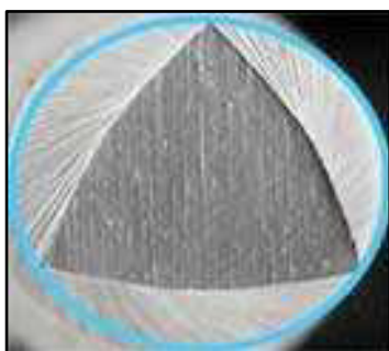
Fig 14: Muestra la sección de corte transversal triangular “redondeada” de ProTaper. 25
