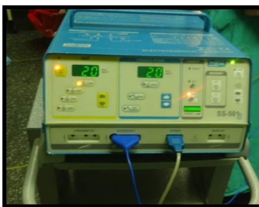
Fig. N°81 Equipo de electrocauterio de la marca WEM Modelo: SS501MCA, programado con 20 W de corte y coagulación, se empleara en modo monopolar para el procedimiento.
