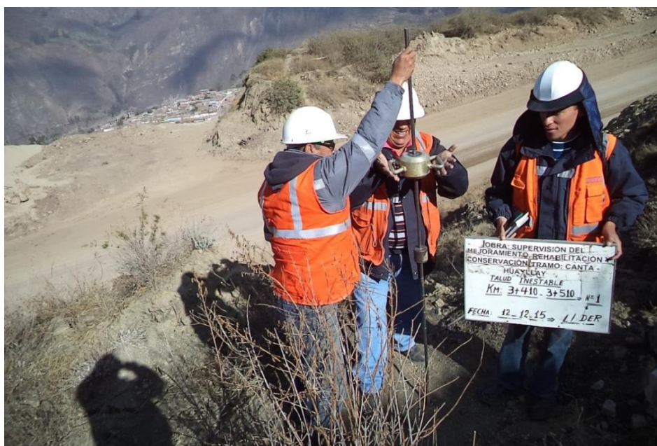
Foto N° 4.7. Ensayo de DPL Km 104+920 – 105+010.
