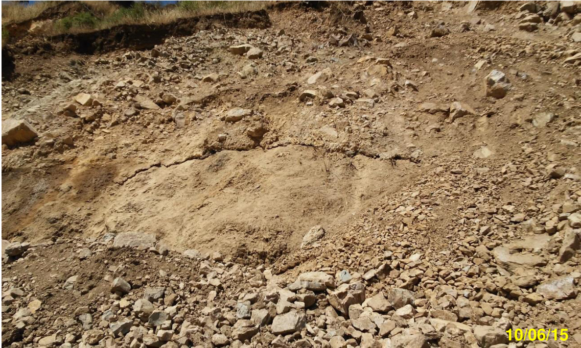
Foto N° 3. Plano de contacto entre el depósito coluvial (arriba) y la roca (base)
