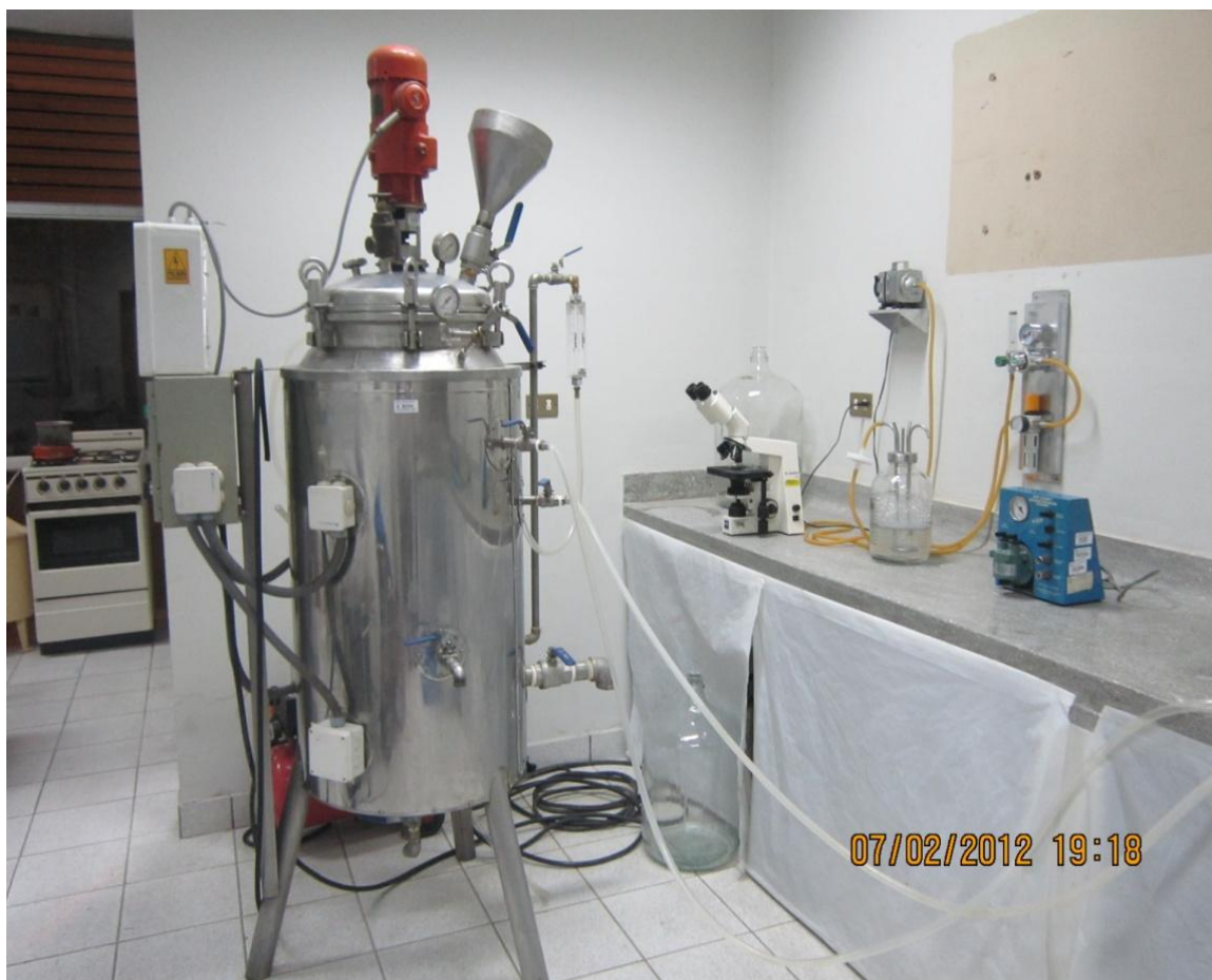
Figura 47 Vista de perfil del Birreactor Batch modelo Tanque Agitado de capacidad operativa de 1hL Ubicado en el Laboratorio de Microbiología Ambiental y Biotecnología de la Facultad de Ciencias Biológicas de la UNMSM.
