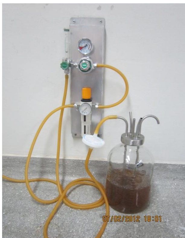
Figura 37 Propagación de Células de Saccharomyces cerevisiae Safale S-40 en medio de cultivo Mosto Cerveceros en frasco Carlsberg.
