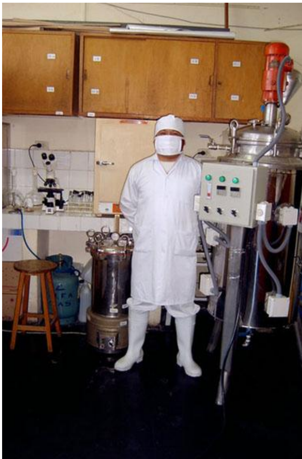
Figura46 Birreactor Batch modelo Tanque Agitado de capacidad operativa de 1hL Ubicado en el Laboratorio de Microbiología Ambiental y Biotecnología de la Facultad de Ciencias Biológicas de la UNMSM .Responsable Dr. Abad Flores Paucarima
