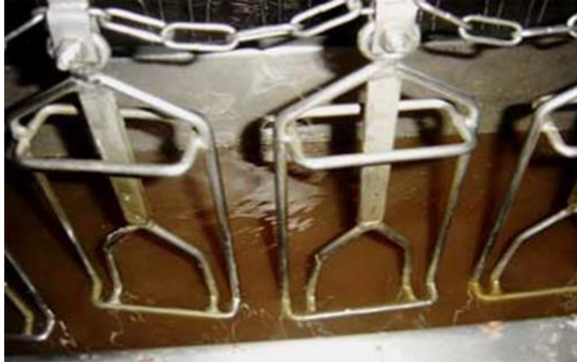
Figura 10. Tanque de escaldado con agua sucia
