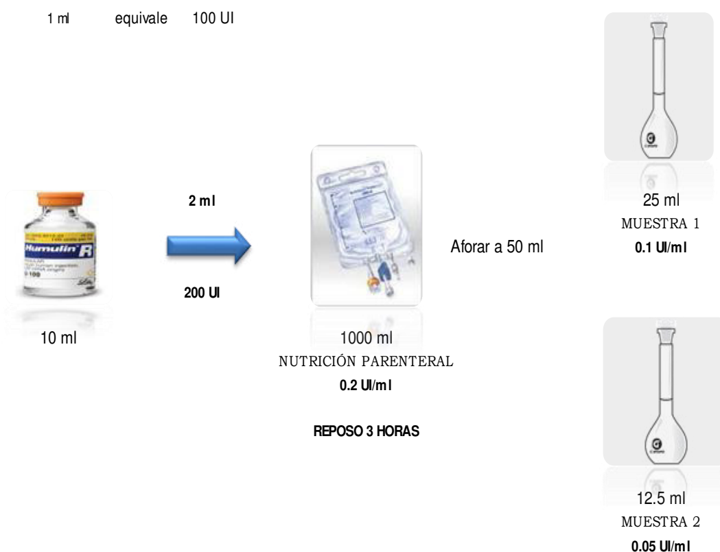
Fig. 5. Diagrama de preparación de las diluciones de muestras a partir de la insulina en estudio.
