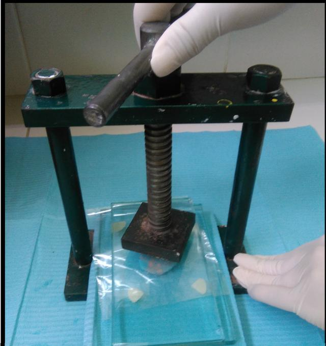
Con una prensa manual y usando dos platinas de vidrio con topes de un milimetro se aplanan las obleas
