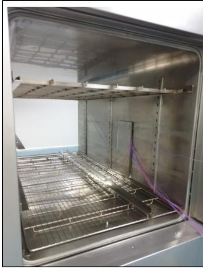
Figura 18. Instalación de termopares en cámara vacía
