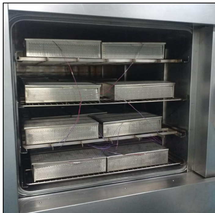
Figura 19. Instalación de termopares dentro de las cacerinas con viales de Lidocaína inyectable
