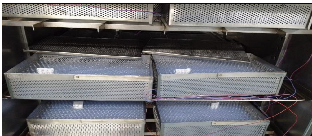
Figura 20. Instalación de termopares dentro de las cacerinas con ampollas de Lidocaína inyectable
