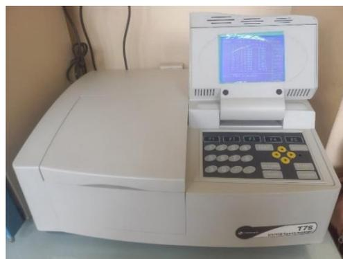
Espectrofotómetro UV- Visible T7S
