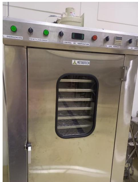
Deshidratador de bandejas con extractor de aire húmedo Metrotech DSG-5I
