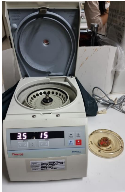
Figura N° 38. Microcentrífuga MicroCL 21 utilizada para la separación de las proteínas de la fracción citoplasmática y la fracción de membrana, para la obtención de antígenos de membrana.
