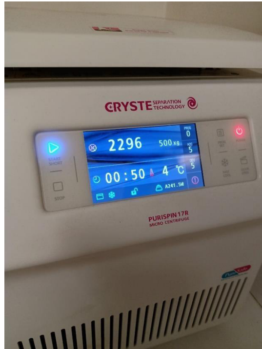
Figura N° 37. Microcentrífuga refrigerada Purispin 17R, utilizada para la obtención de la fracción de membrana en el paso final para la obtención de antígenos de membrana.
