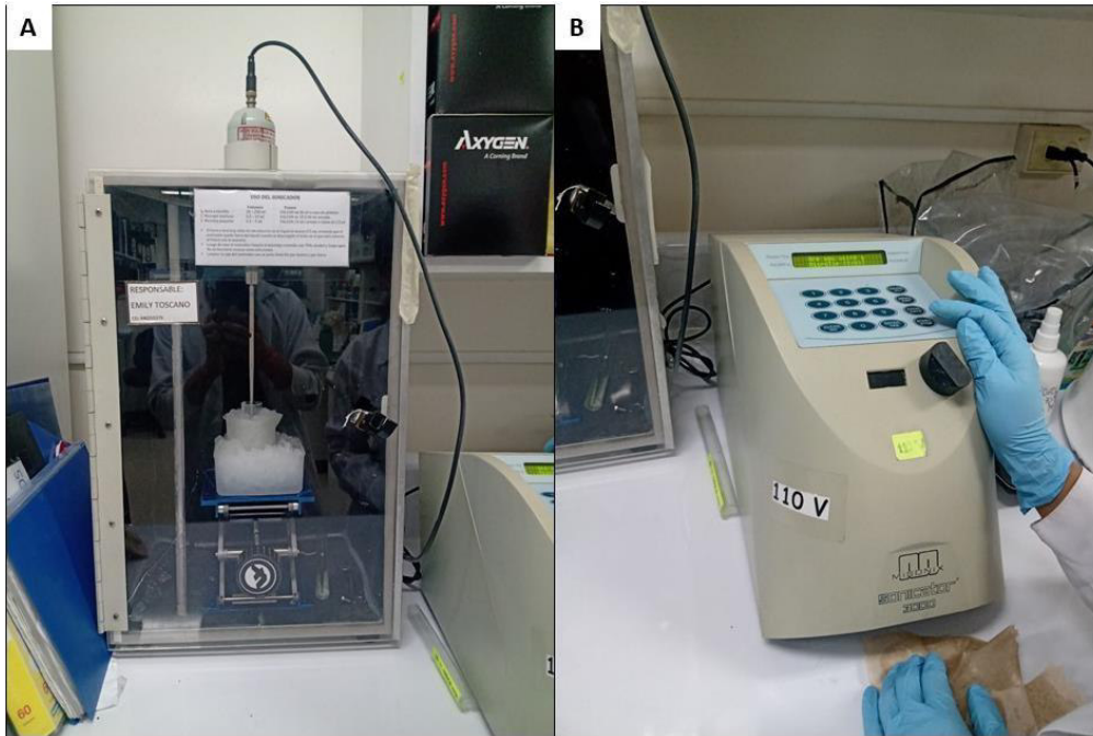
Figura N° 36. Sonicator empleado para el fraccionamiento de taquizoitos. (A) Taquizoitos de T. gondii en PBS colocados en hielo listos para ser sonicados para la obtención de antígeno total lisado (TLA) y antígenos de membrana (AM). (B) Sonicator Misonix 3000.
