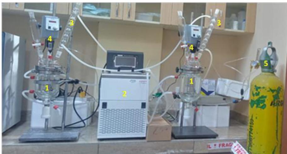
*Nota.* <sup>1</sup>Reactores de tanque agitado, <sup>2</sup>Baño termostático, <sup>3</sup>Condensadores, <sup>4</sup>Agitador mecánico, <sup>5</sup>Balón de gas  $\text{N}_2$
