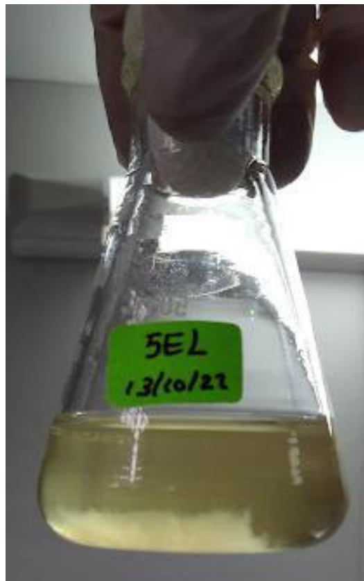
Figura 18. En todos los matraces se vieron dos fases, en el fondo se pudo evidenciar una precipitación blanquecina con la biomasa.
