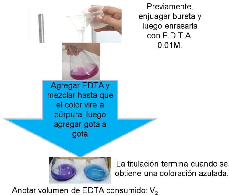
Figura 6. Metodología en valoración complejométrica para evaluar la remoción del ion calcio. (1) Preparación de la muestra y (2) Valoración con EDTA. En la parte inferior se observa el matraz izquierdo (último rastro de color púrpura justo antes del punto final) y el matraz derecho (color azul claro en el punto final).
