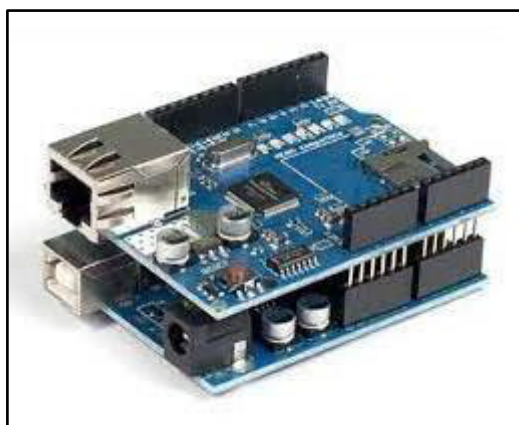
Figura 33. Unión entre Arduino Uno y Ethernet Shield. Fuente: Elaboración propia
