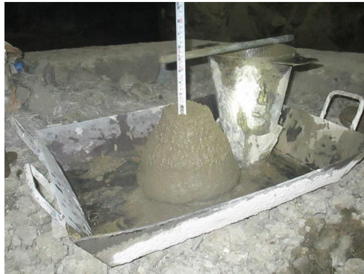
Figura 51. Control del revenimiento del concreto con relave.
