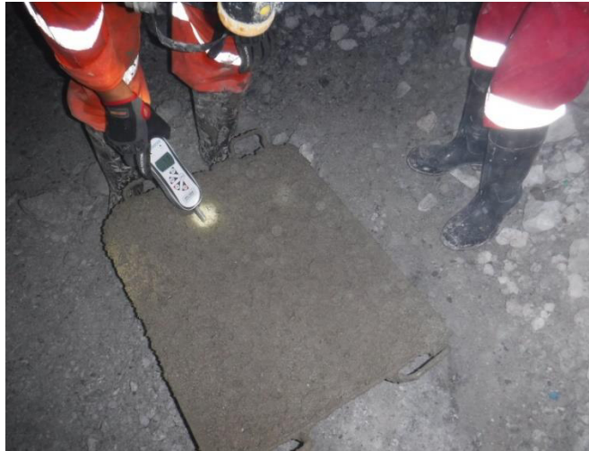
Figura 27. Medición de la velocidad de la fragua inicial del concreto con relave, para analizar la resistencia durante las primeras horas, se mide con un dinamómetro digital.
