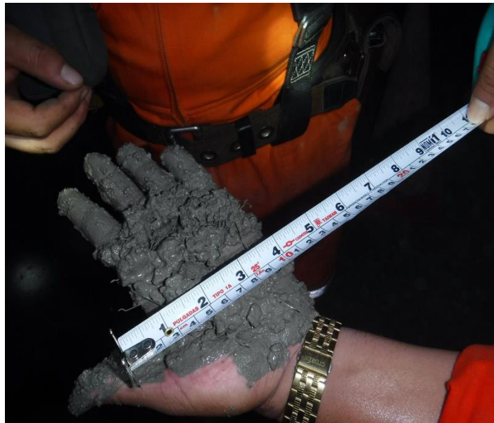
Figura 28. Foto demostrativa visual de la consistencia del concreto con relave.
