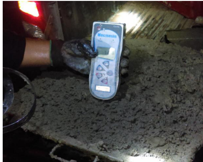
Figura 52. Penetración del concreto lanzado fresco usando penetrómetro digital marca Mecmesin AFG 1000.
