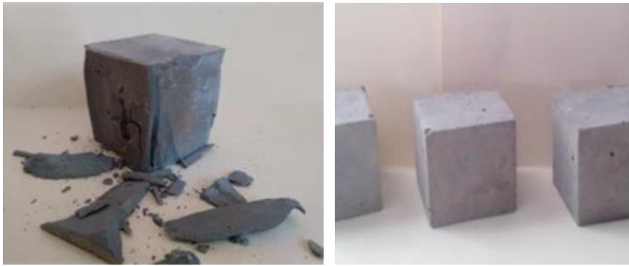
Figura 29. Resistencia a la compresión (Kg/cm 2 ) del relave v/s cemento.
