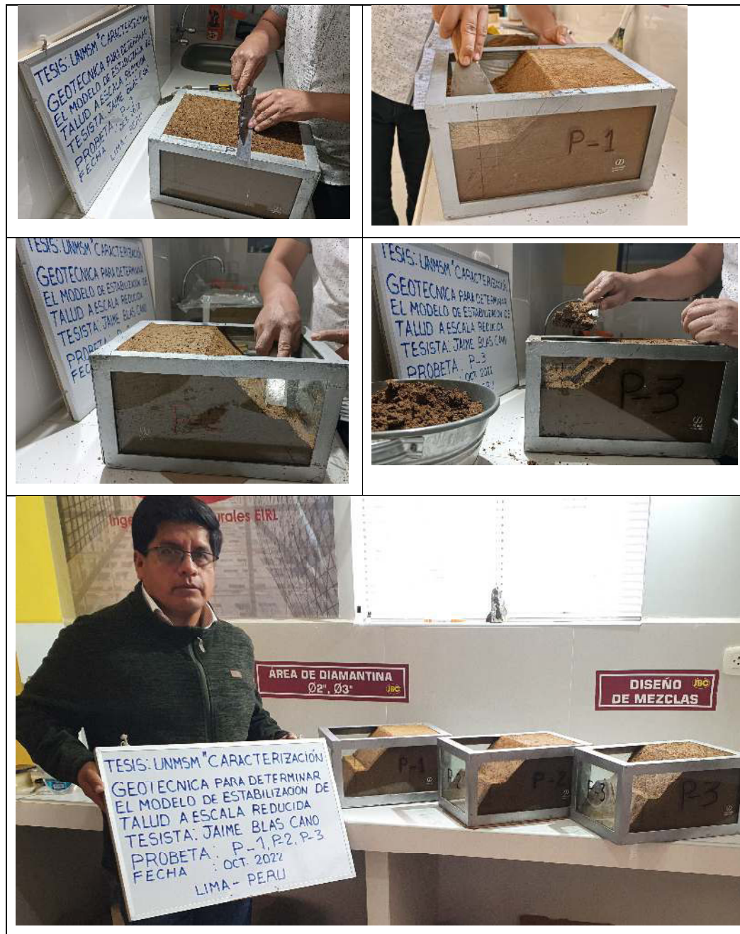
Figura 55. Proceso de conformación del modelo talud estabilizado a escala reducida.
