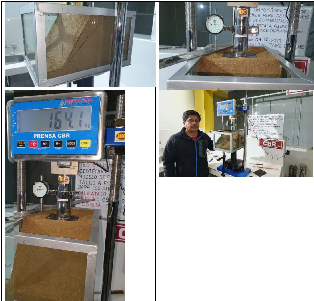
Figura 57. Proceso de ensayo de talud natural en máquina de carga CBR.
