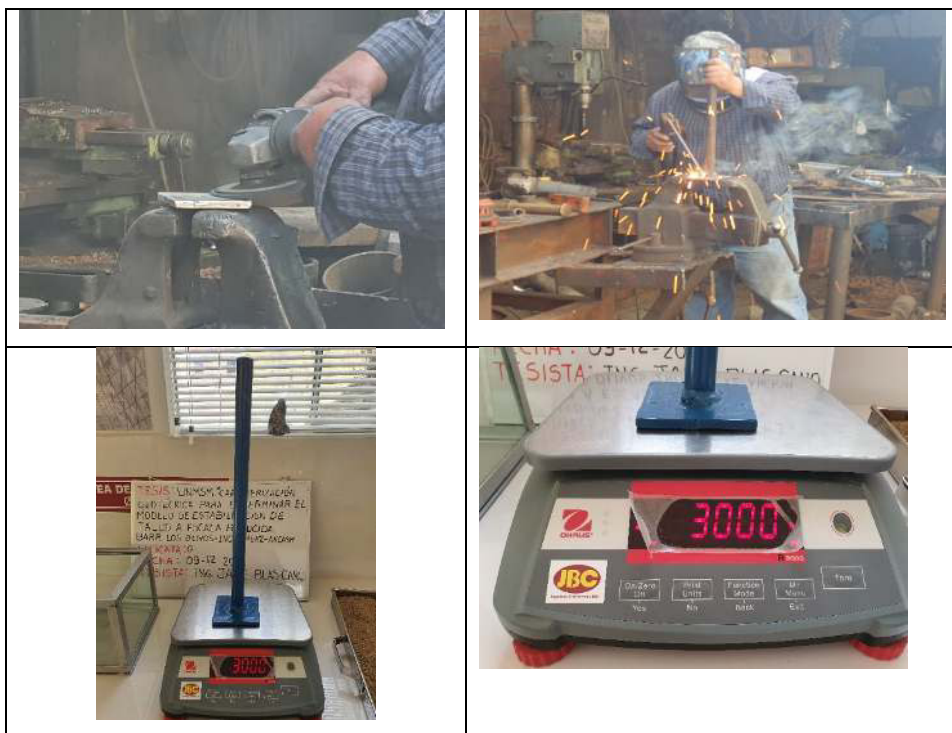
Figura 47. Construcción del pisón para de ensayos a escala reducida
