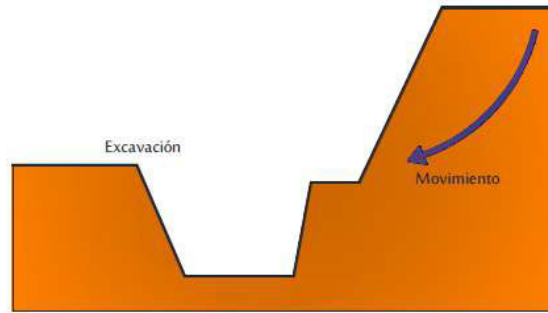
Figura 18. Excavación al pie del talud
