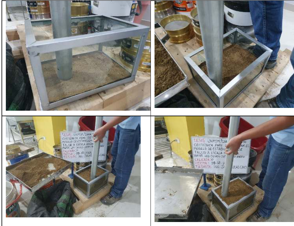
Figura 53. Proceso de compactado con pisón de Proctor modificado peso de martillo 4545g.
