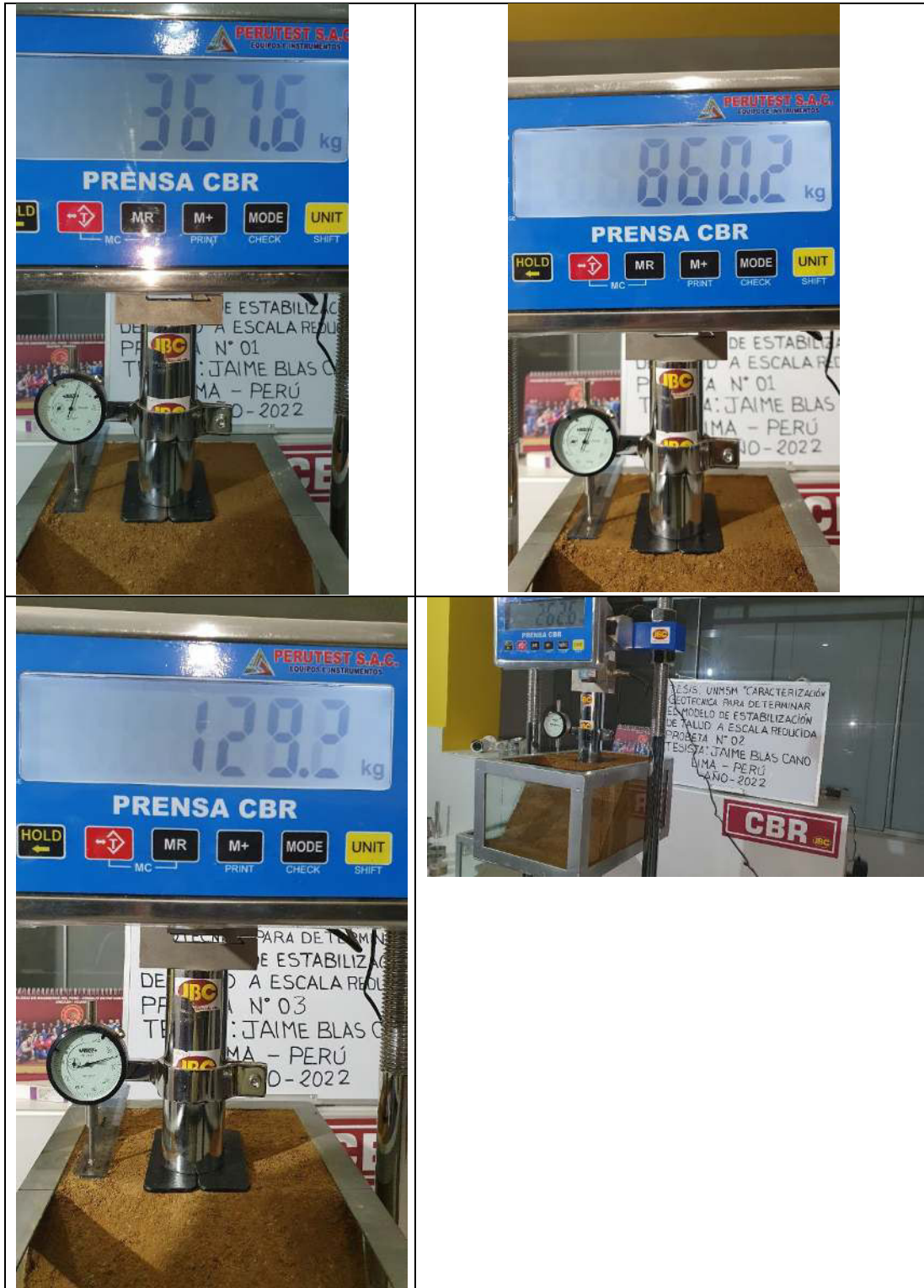
Figura 59. Proceso de ensayo de talud natural en máquina de carga CBR. Secuencia de toma de datos de esfuerzos y deformaciones.
