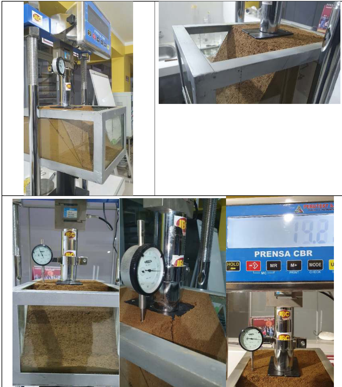
Figura 58. Proceso de ensayo de talud natural en máquina de carga CBR. Se visualizan las grietas
