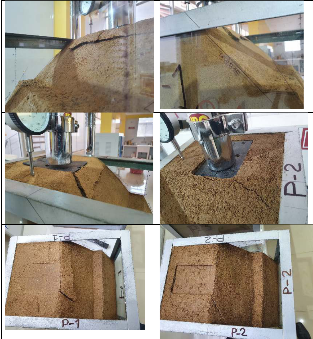
Figura 60. Proceso de ensayo de talud natural estabilizado en máquina de carga CBR. Se observa las grietas luego del ensayo de carga.
