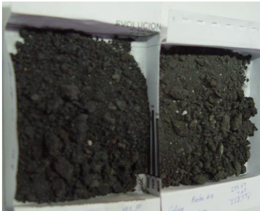
Calcinas de Tostación
