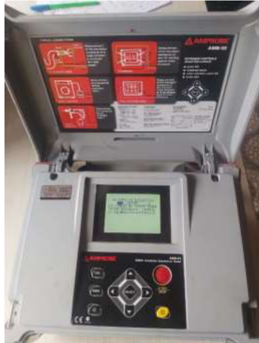
Figura 4: Megómetro Amprobe AMB-55 Fuente: Elaboración Propia
