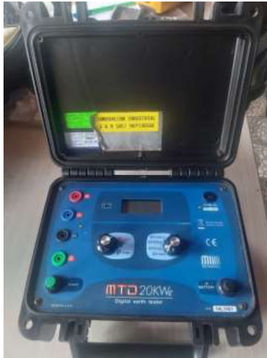
Figura 5: Telurómetro Megabras MTD20KWe Fuente: Elaboración Propia
