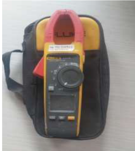
Figura 6: Pinza amperimétrica 374FC Fluke Fuente: Elaboración Propia
