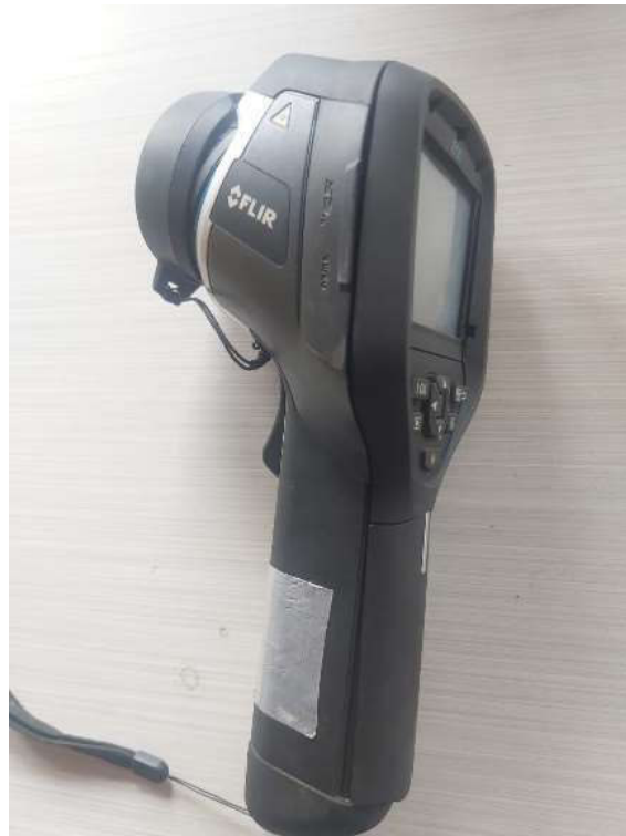
Figura 8: Cámara termográfica FLIR E49 Fuente: Elaboración Propia
